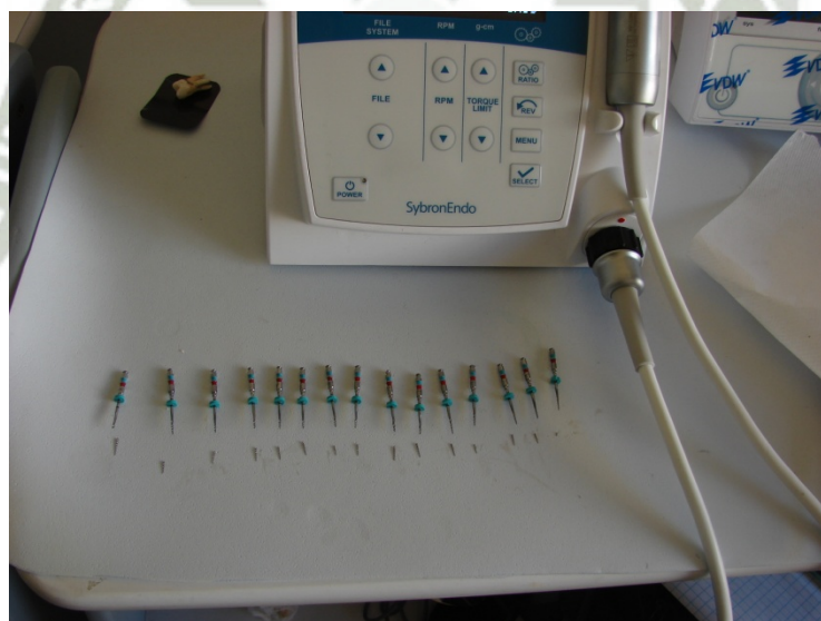
Instrumentos después de sufrir fatiga cíclica con sus respectivos fragmentos fracturados
