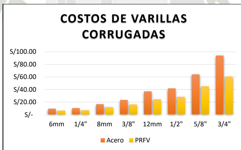
Figura 11 Comparación gráfica de los costos unitarios de varillas corrugadas de acero y el polímero reforzado con fibras de vidrio (PRFV) según el diámetro
