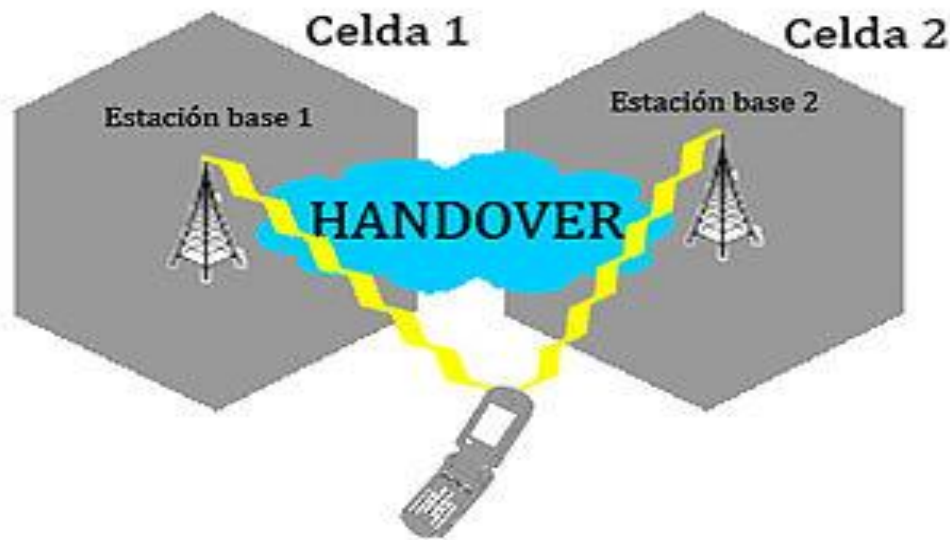
Figura 7. Esquema de handover entre dos celdas y sus BTS en el centro de cada celda Fuente: https://es.wikipedia.org/wiki/Handover
