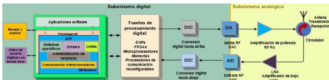
Figura 4. Arquitectura de un sistema SDR ideal.
