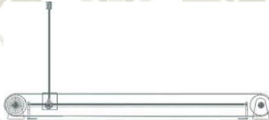
*Figura 2.4. Esquema del péndulo invertido sobre un carro.*
