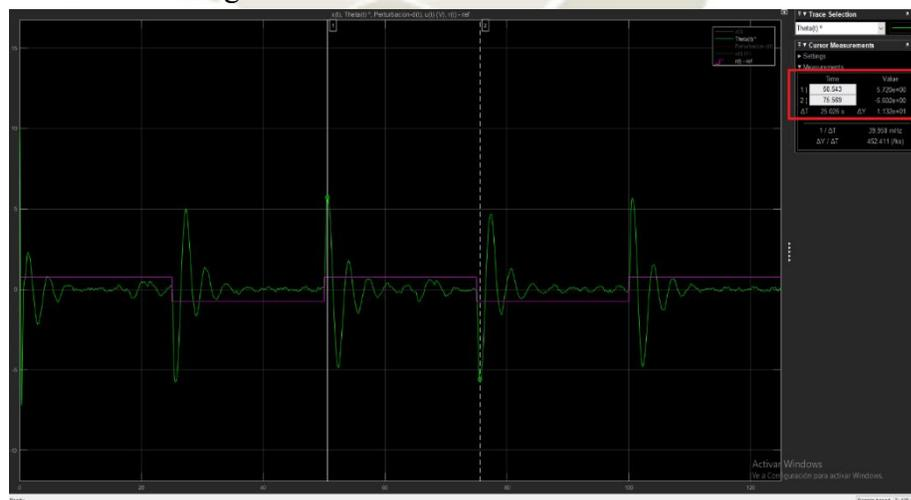
Figura 5.111. Intervalo de valores del ángulo  $\theta(t)$  para el servosistema de control por ubicación de polos con filtro de Kalman
