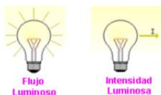
Figura 3 Diferencia entre flujo e intensidad luminosos
