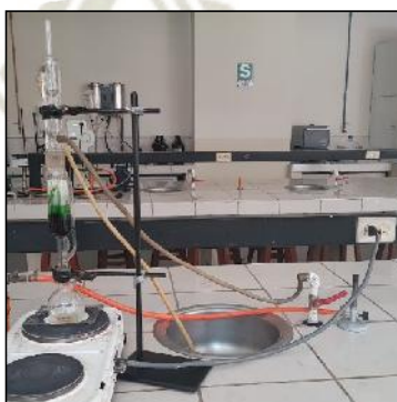
FIGURA N° 3.2. Obtención del extracto hidroalcohólico de Foeniculum vulgare M. mediante Soxhlet
