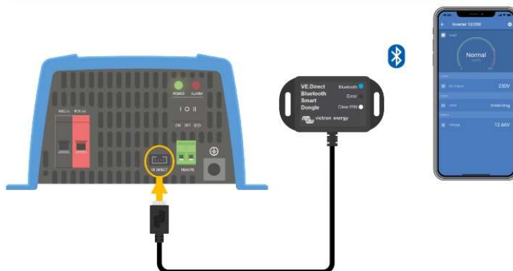
Esquema de conexión de la mochila VE.Direct Bluetooth Smart
