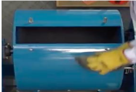
Figura 21. Colocación de esferas en la máquina de los ángeles.
