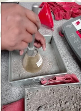
Figura 6. Prueba de absorción del agregado fino
