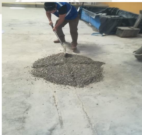
Figura 22. Cuarteo de muestra gruesa
