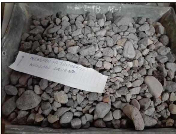
Figura 9. Agregado grueso con superficie seca
