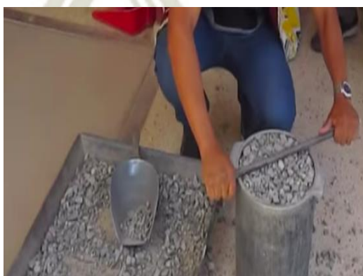
Figura 16. Enrasado de muestra de agregado grueso.
