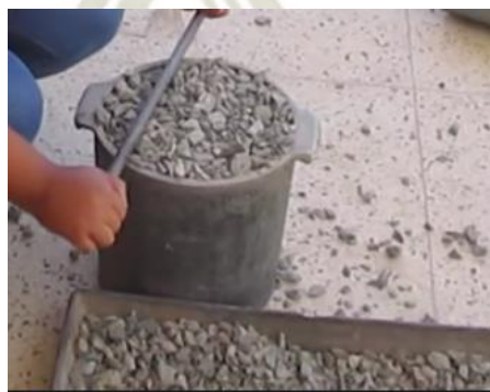
Figura 18. Enrasado de la superficie del agregado grueso
