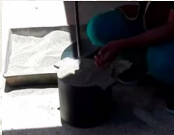
Figura 13. Compactado de muestra de agregado fino.
