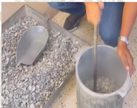
Figura 15. Compactado de muestra de agregado grueso.
