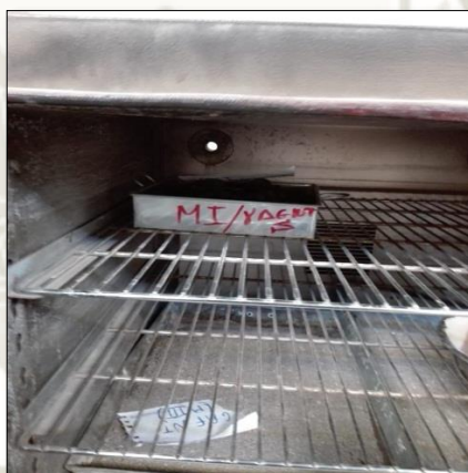
Figura 12. Secado de la muestra gruesa en horno
