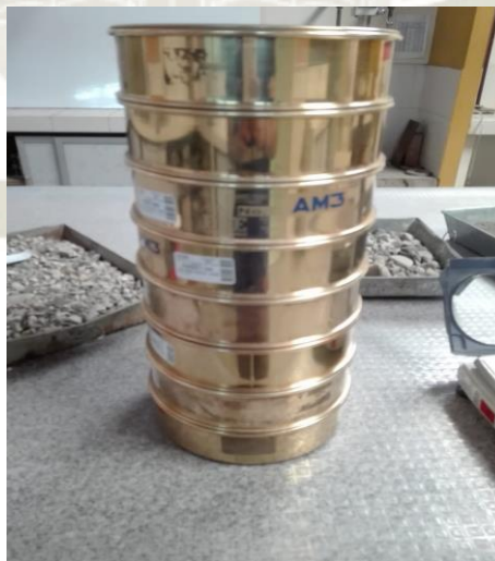
Figura 23. Tamizado de agregados
