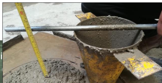
Figura 1: Prueba de Slump concreto fluido.
