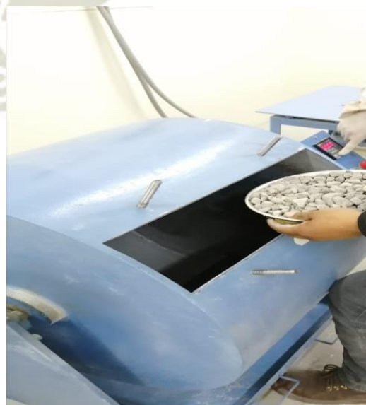
Figura 31. Colocación de material para ensayo en la maquina de los ángeles.
