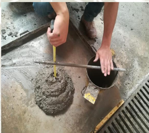
Figura 25 Medicion del asentamiento del concreto fluido
