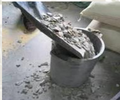
Figura 17. Vaciado del agregado grueso en el molde
