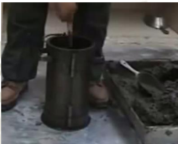
Figura 26. Compactado de los especímenes de concreto
