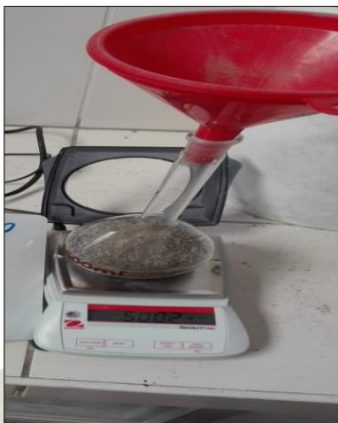
Figura 8. Peso del picnómetro + peso de la muestra + agua
