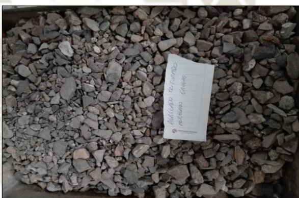
Figura 10. Peso de la muestra gruesa con superficie seca
