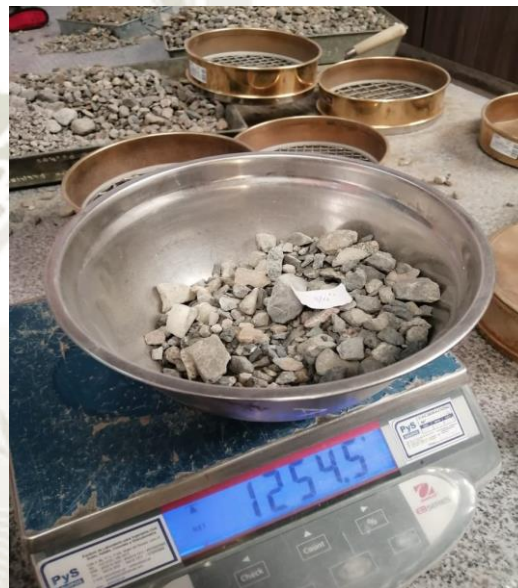
Figura 31. Colocación de material para ensayo en la maquina de los ángeles.
