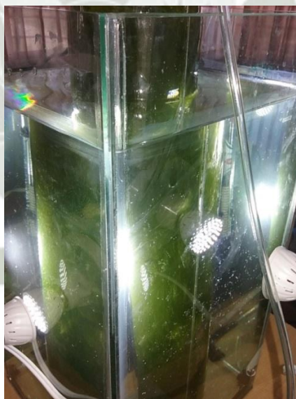
Figura 35 Fotobiorreactor (FBR) tubular de 5L a los 4 días, en periodo de luz
