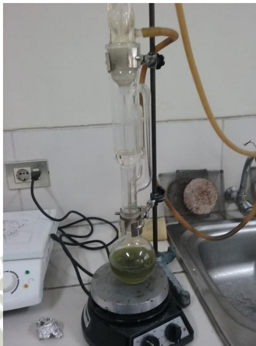
Figura 38 Extracción de aceite por soxhlet
