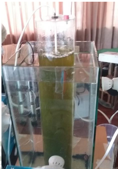
Figura 34 Fotobiorreactor (FBR) tubular de 5L a los 2 días, en periodo de oscuridad
