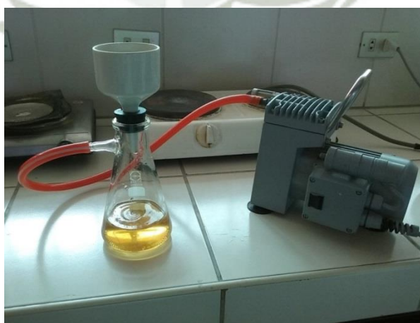
Figura 13 Filtración del Te de Compost
