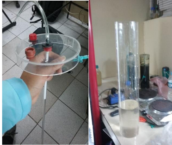
Figura 18 Construcción del fotobiorreactor.
