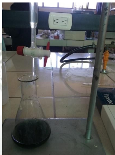
Figura 30 Determinación del contenido de materia orgánica, titulación de la muestra
