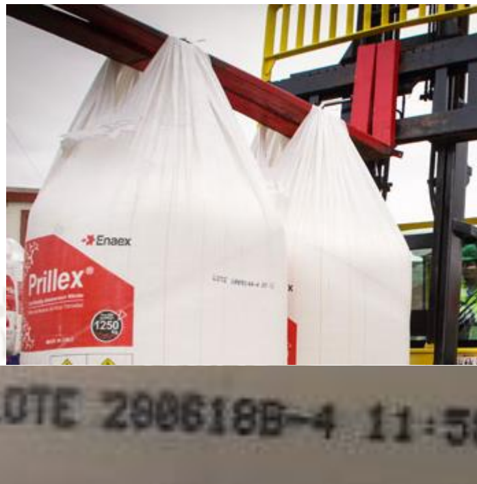
Figura 89. Impresión del lote y fecha en el maxi saco por maquina Scorpion SQ2 (ENAEX, 2019)
