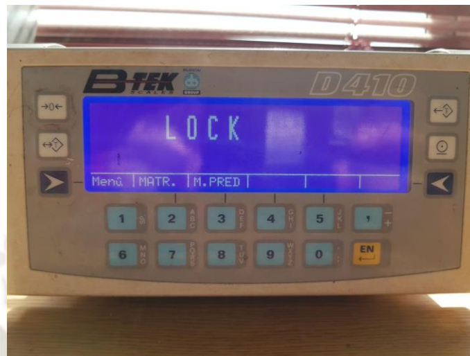
Figura 65. Indicador de peso de alto tonelaje marca BTEK, usado en el pesaje de camiones con Nitrato de Amonio Prill (Planta Prillex, 2018)
