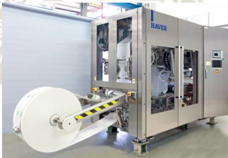
Figura 83. Maquina ensacadora sacos de 25 kg FFS (HAVER BROECKER, 2019)
