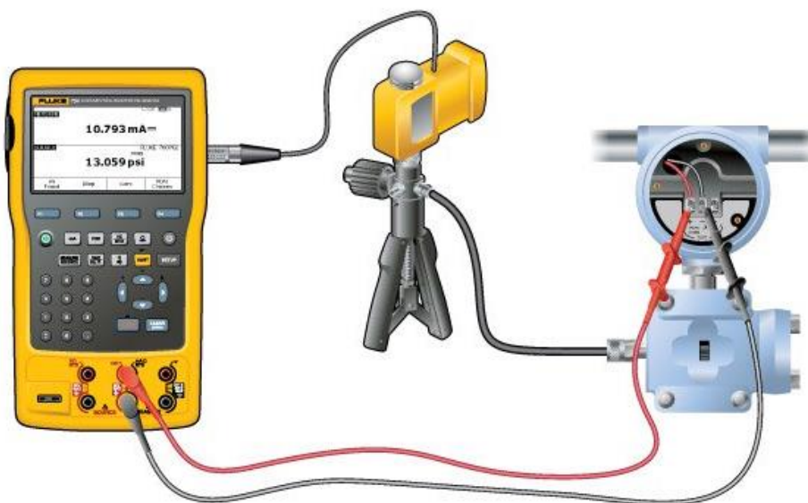
Figura 68. Conexión de instrumentos para la calibración de un sensor de presión (FLUKE, 2019)
