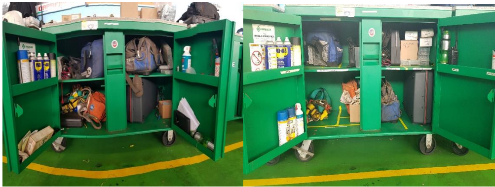
Figura 31. Antes y después de aplicar 5'S en cajón de herramientas (Planta Prillex, 2018)
