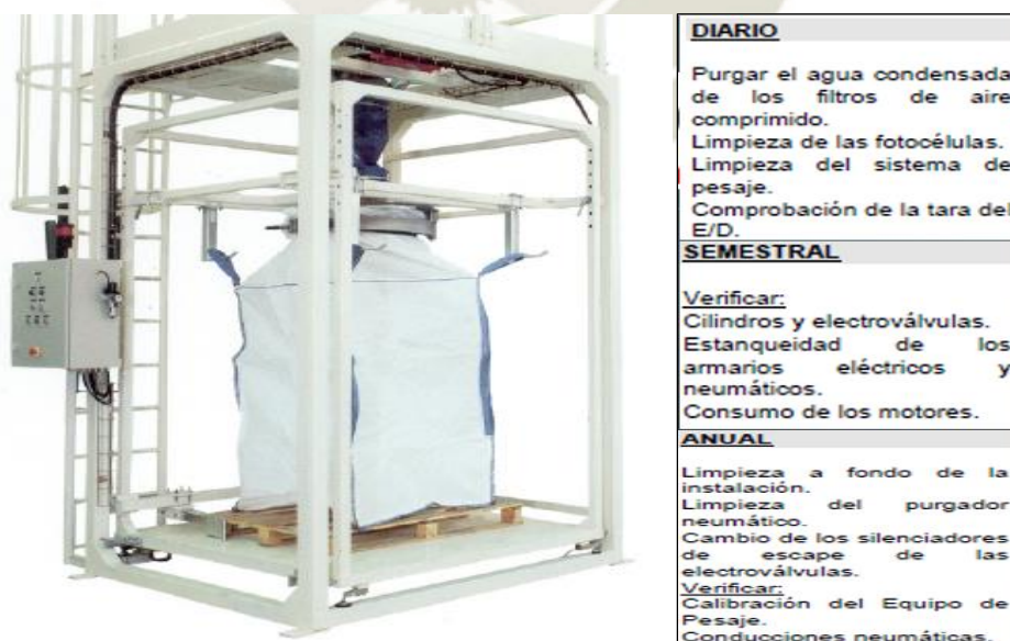
Figura 40. Máquina ensacadora de Maxi Sacos de 1000 a 1300 kg, a su derecha, Planes de mantenimiento en diferentes frecuencias (Payper, 2019)
