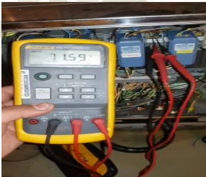
Figura 48. Recopilación de datos de un transmisor de temperatura para el análisis de una falla (ENAEX, 2019)
