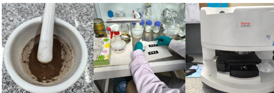
Figura 53. Protocolo de preparación para el análisis por FTIR
