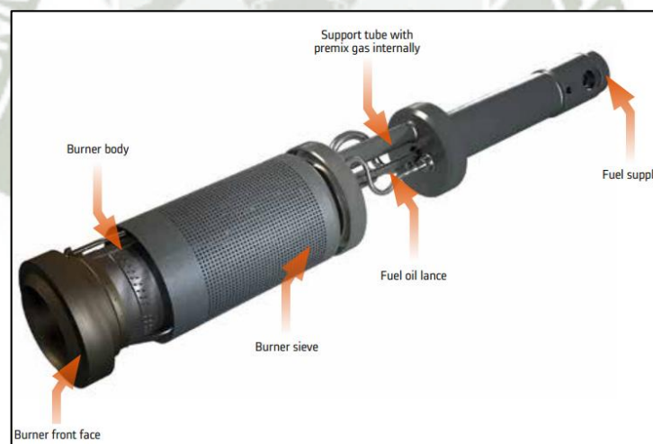
Figura II-16 Quemador AEV de Alstom 9
