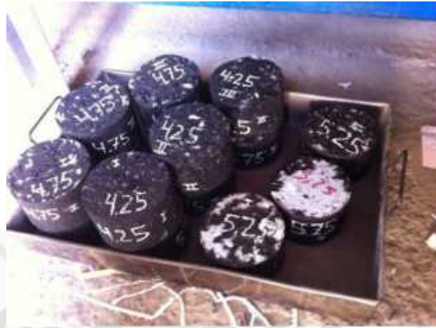
FIGURA 2.4 Quince unidades de probetas para su peso al aire
