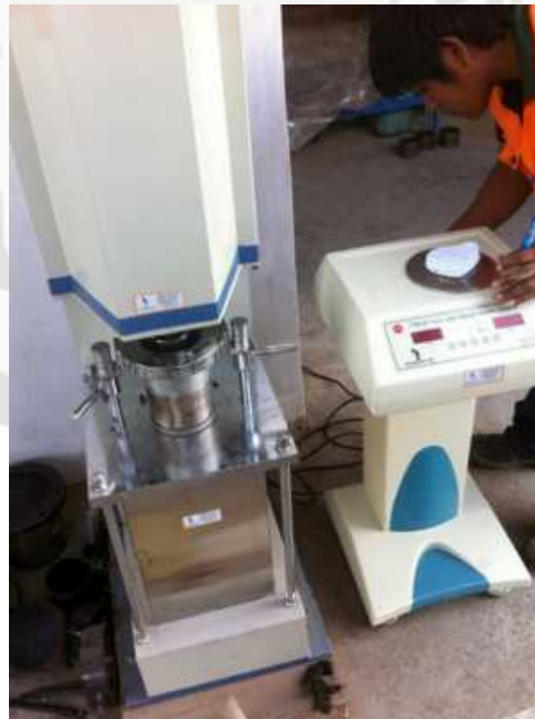
FIGURA 2.5 Equipo compactador Marshall con control de funcionamiento
