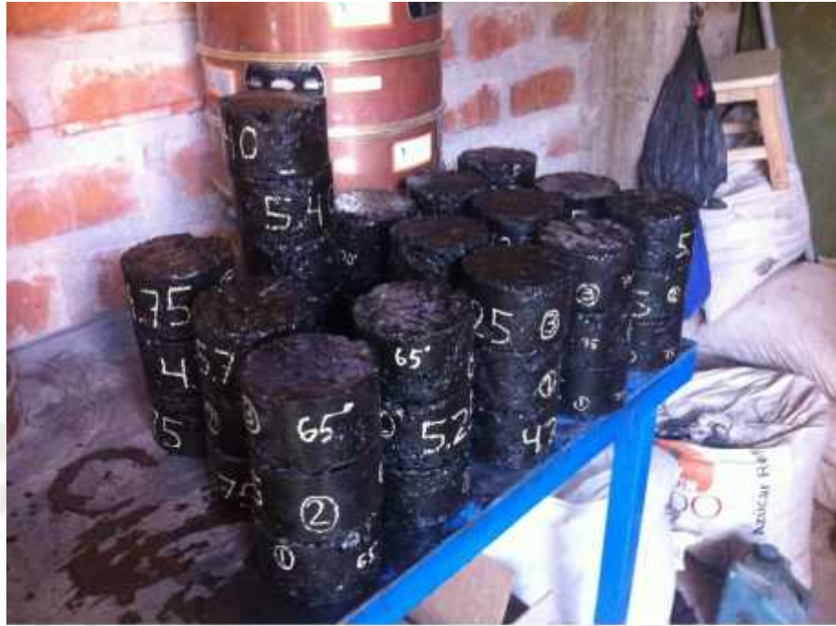
FIGURA 2.11 Cuarenta y cinco probetas PEN 80/100
