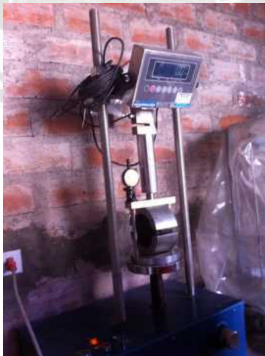
FIGURA 2.11 Ensayo Marshall en probeta de mezcla asfáltica
