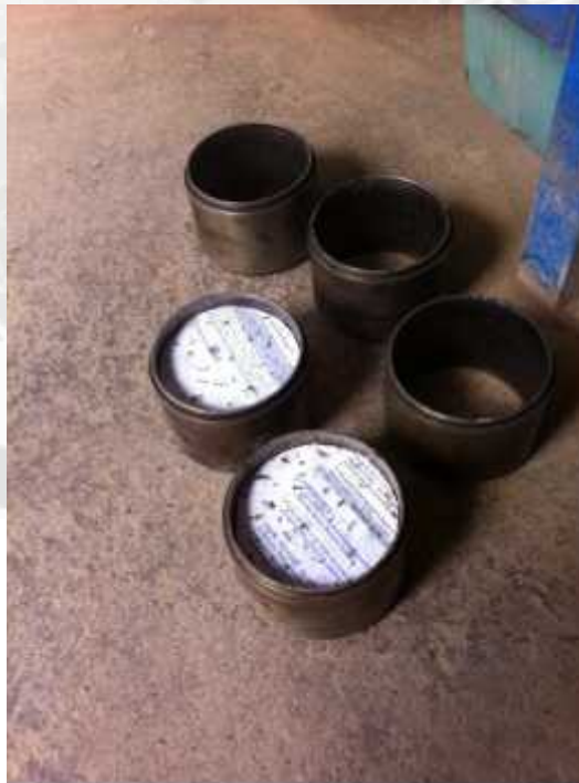
FIGURA 2.3 Moldes del Marshall para la elaboración de probetas
