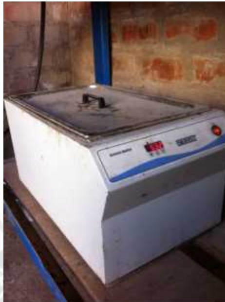
FIGURA 2.7 Baño María calentando a los 60°C
