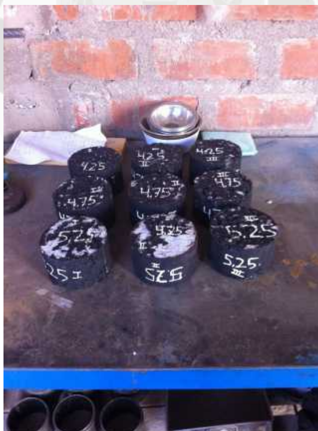
FIGURA 2.9 Desmolde del segundo juego de probetas del diseño Marshall
