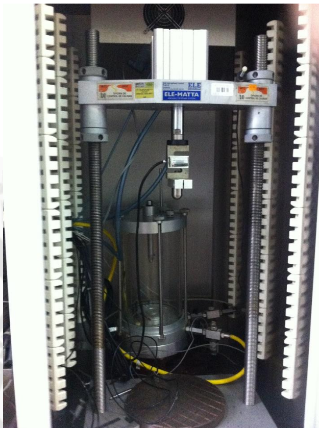
FIGURA 3.2 Cámara de refrigeración UMATTA en el MTC, fuente (Fotografía Carlos Ramos Guerra-MTC, Dirección de Estudios Especiales)
