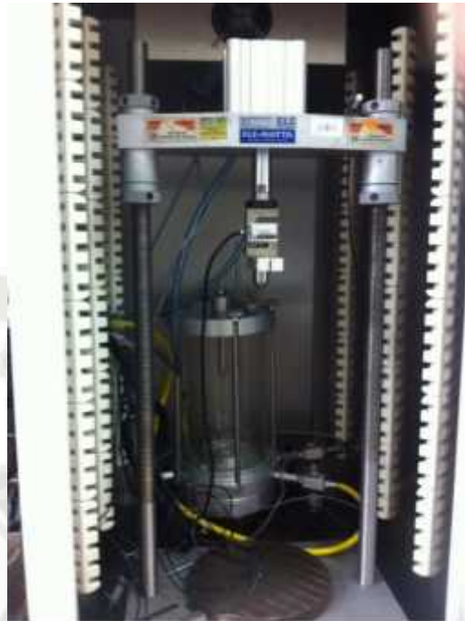
FIGURA 1.14 UMATTA – Máquina de módulo resiliente con cámara de temperatura en el MTC
