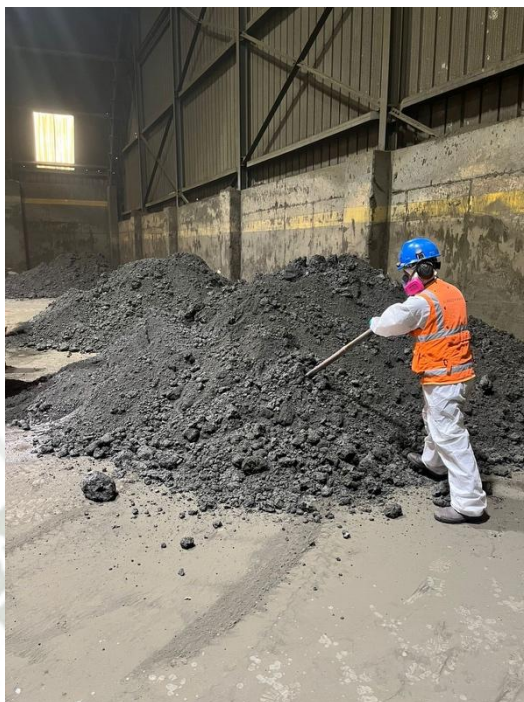
Figura 23. Toma de 8 incrementos con la sonda de 1.1m x 2''
