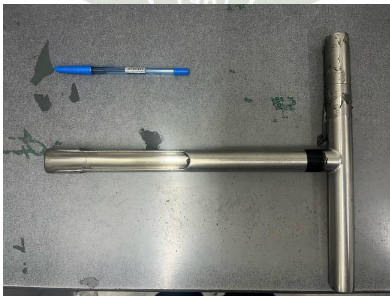
Figura 7. Sonda tubular de 0.30 m x 1" de diámetro
