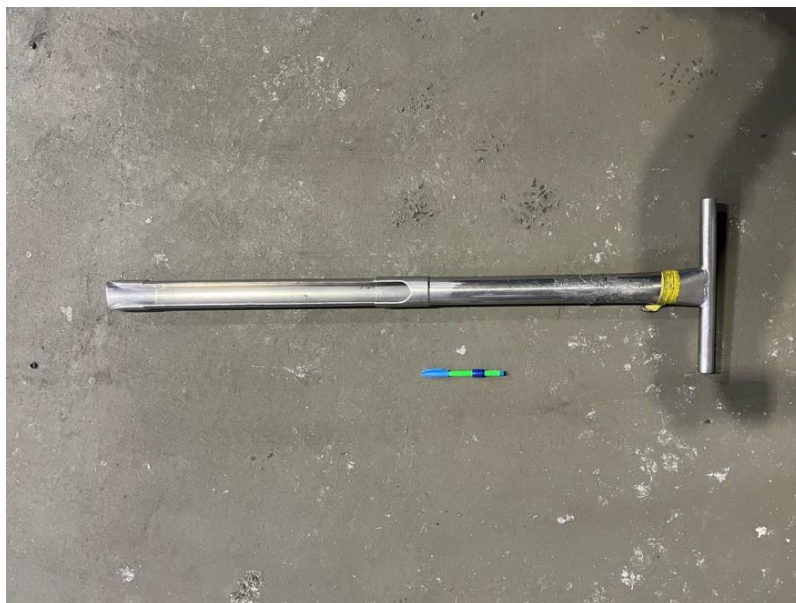
Figura 8. Sonda tubular de 1.1 m x 2" de diámetro
