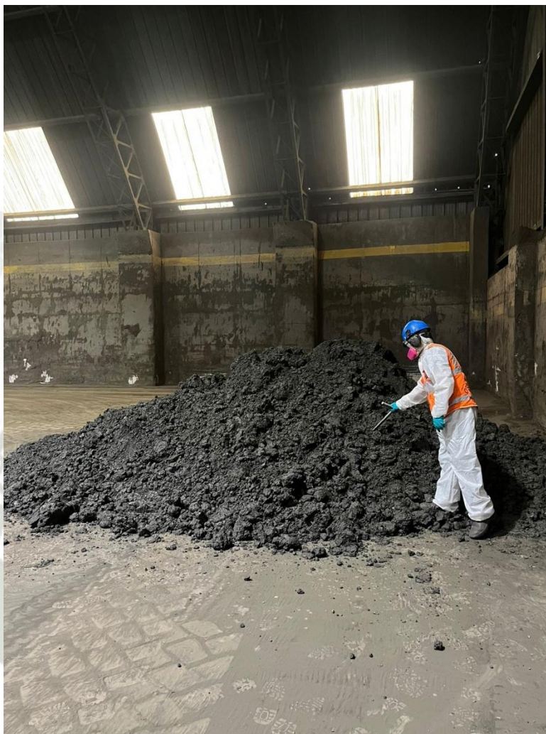
Figura 21. Toma de 15 incrementos con la sonda de 0.30 m x 1" en la ruma de Zn
