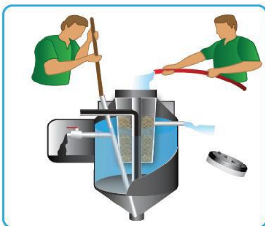
Figura 6.18 Limpieza y Mantenimiento del Biodigestor
