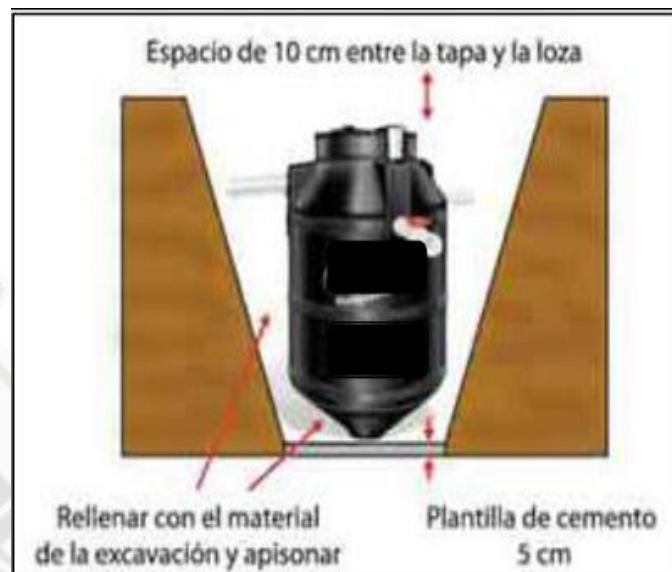
Figura 6.12.- Excavación para colocación del Tanque Biodigestor
