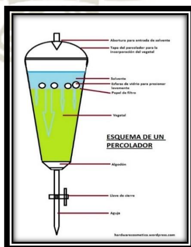
Figura 10: Esquema del equipo de percolación.
