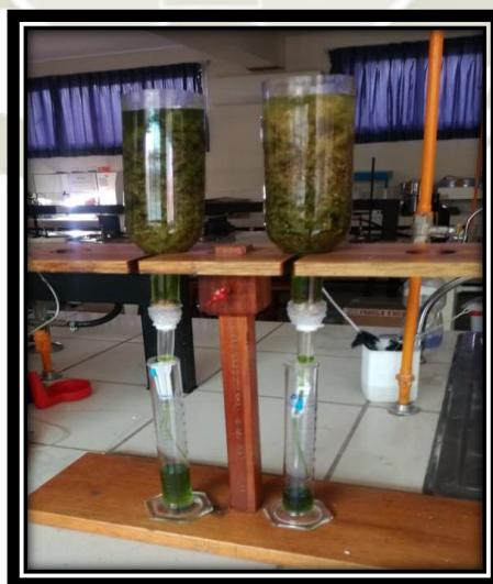
Figura 11: Equipo de percolación artesanal con muestra de las hojas de Culcitium canescens "Vira Vira"
