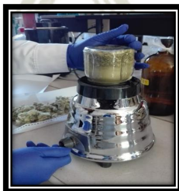
Figura 9: Proceso de pulverización de las hojas de Culcitium canescens "Vira Vira".
