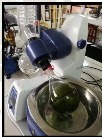
Fig. 5: Concentración del extracto
