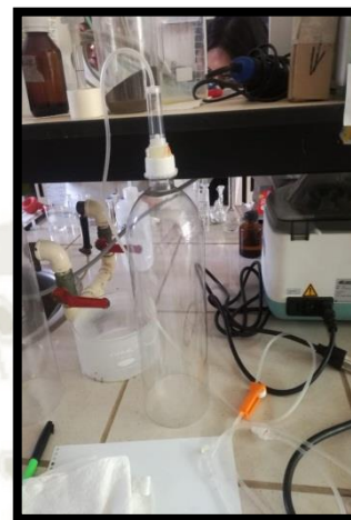
Fig. 3: Elaboración del Percolador.
