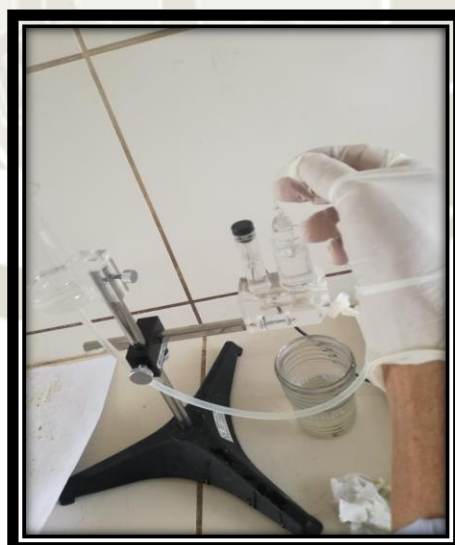
Figura 13: Calibración del equipo de pletismómetro
