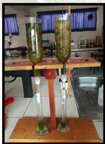
Fig. 4: Percolación de la muestra.
