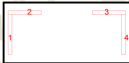
Figura 62: División de sección compuesta en elementos simples para cálculo de propiedades geométricas
