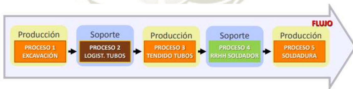
Figura 11: Flujo de Procesos con procesos de soporte de la actividad "Tendido de Tubería"
