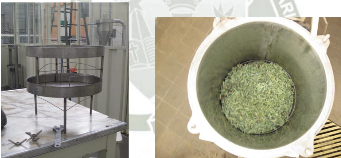
Fig. 2. Canastillas del extractor ( izquierda ) y tanque de acero ( derecha ) de aceite esencial de salvia
