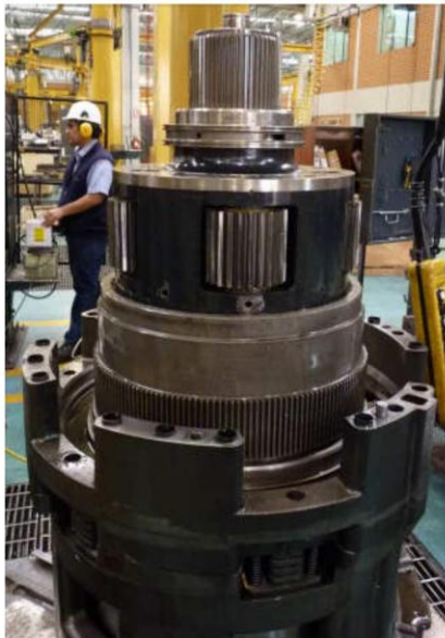
Los engranajes de la sexta reducción planetaria muestran Scoring en los dientes.
