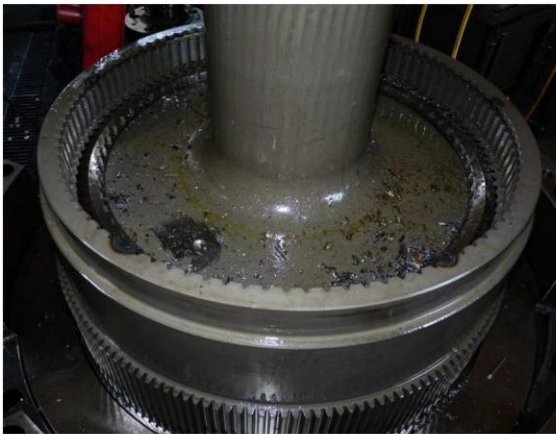
Se tuvo problemas para desacoplar el Carrier #5. Se tuvo que realizar trabajos en el Área de Soldadura para desacoplar el componente.
