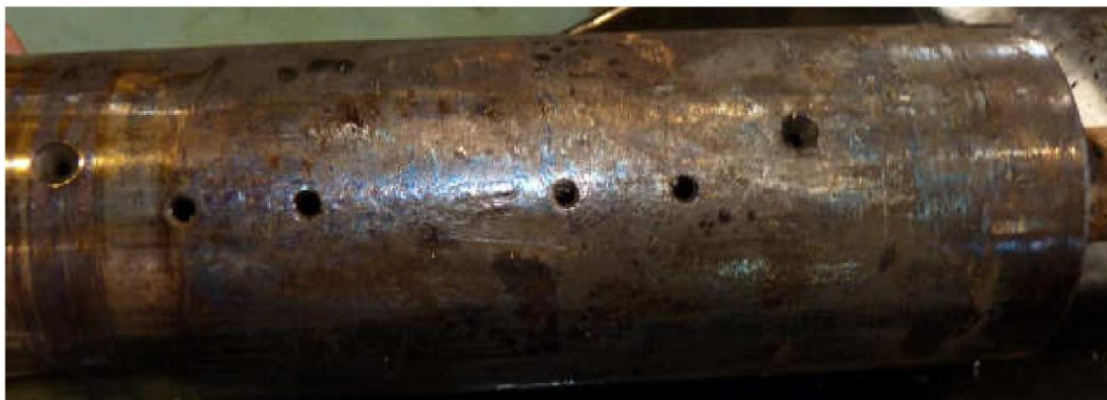
En una superficie del eje N/P 333-1174 se observó desgaste por fatiga superficial de tipo spalling. La coloración por temperatura que se observa en el eje fue generado por el calor al momento de cortar los componentes del Carrier.
