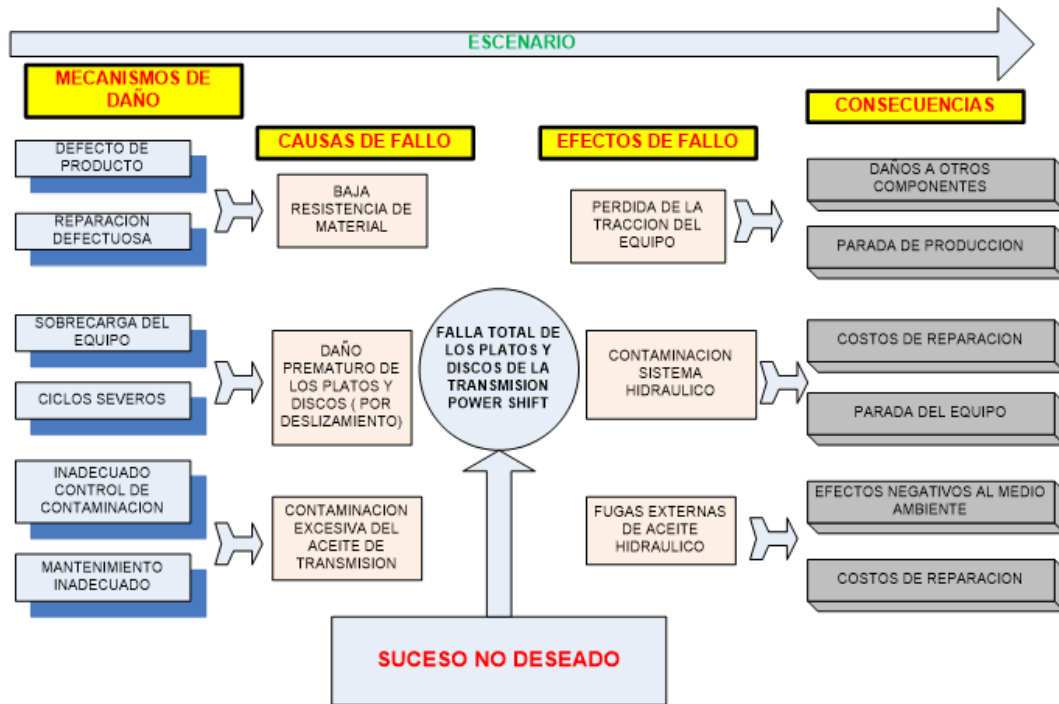
Gráfico N° 16: Falla total de los platos y discos de la transmisión power shift Fuente: Elaboración propia
