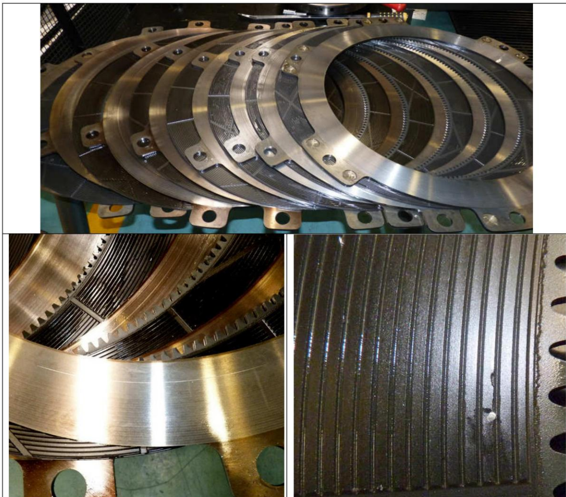
Paquete # 7. Los platos presentaron rayaduras circunferenciales a consecuencia de las partículas metálicas contaminantes, partes de éstas se encontraron adheridas a los discos de fricción.
