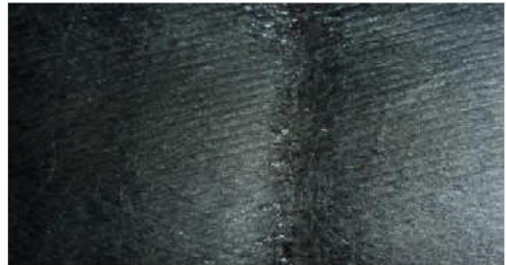
20/06/2015 Muestra Filtro Transmisión: partículas Fe en regular cantidad.
