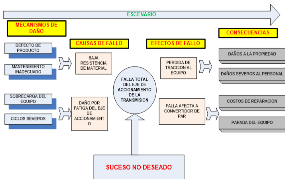
Gráfico N° 11: Falla total del eje de accionamiento de la transmisión
