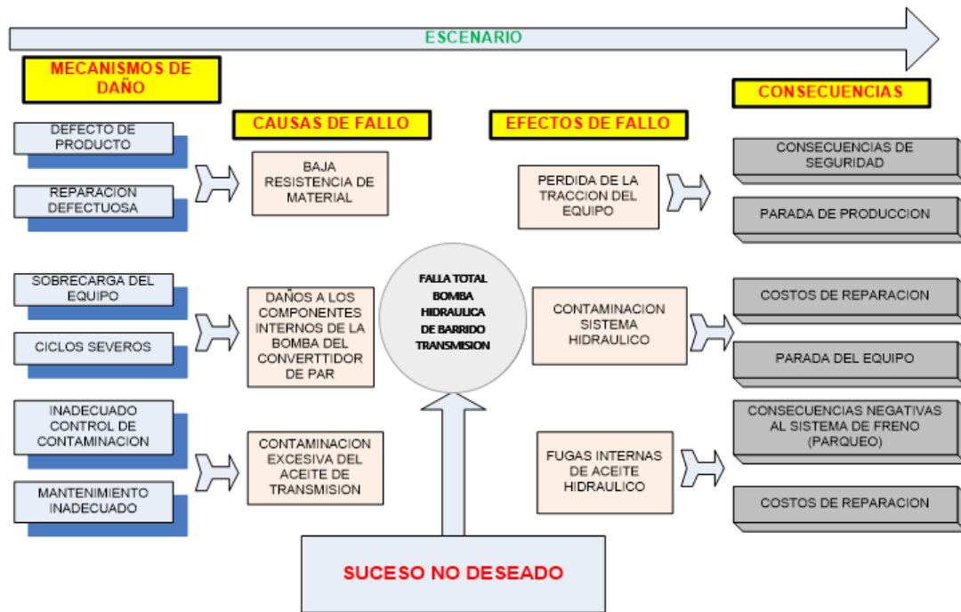
Gráfico N° 18: Falla total bomba hidráulica de barrido transmisión
