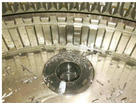
Eje planetario girado en su alojamiento.
