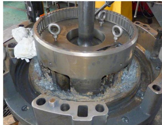
Se tuvo problemas para desacoplar el Carrier #5. Se tuvo que realizar trabajos en el Área de Soldadura para desacoplar el componente.
