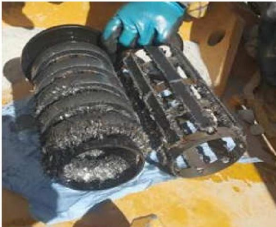
20/06/2015 Muestra Filtro Transmisión: partículas Fe en regular cantidad.
