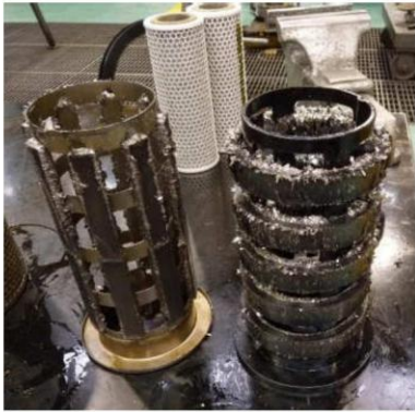
Partículas metálicas en el Screen de la transmisión.
