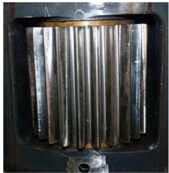
Los engranajes de la sexta reducción planetaria muestran Scoring en los dientes.
