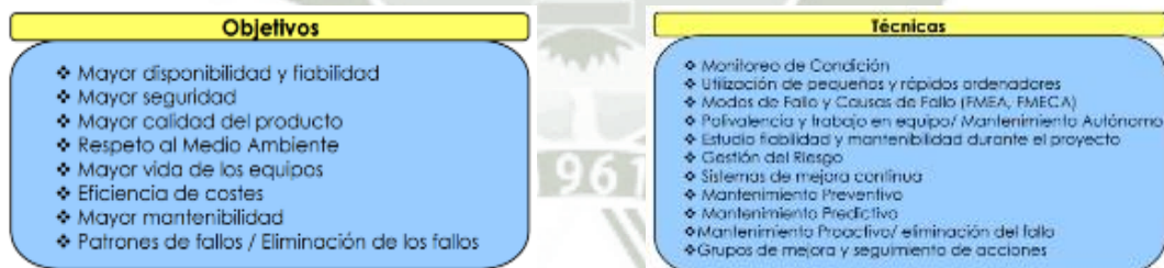
Figura N° 63: Características de Mantenimiento de la Cuarta Generación Fuente: Khan F.I., Haddara A M., (2008). Mantenimiento Basado en el Riesgo (RBM). (p.155). Editorial Mc Graw Hill. España Pra Edición
