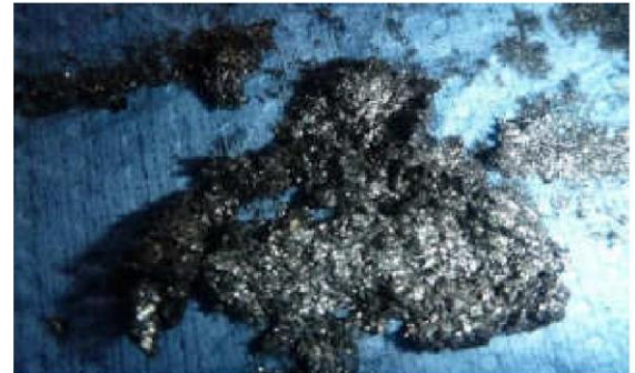
12/06/2015 Muestra Rejilla Transmisión: regular partículas Fe.
