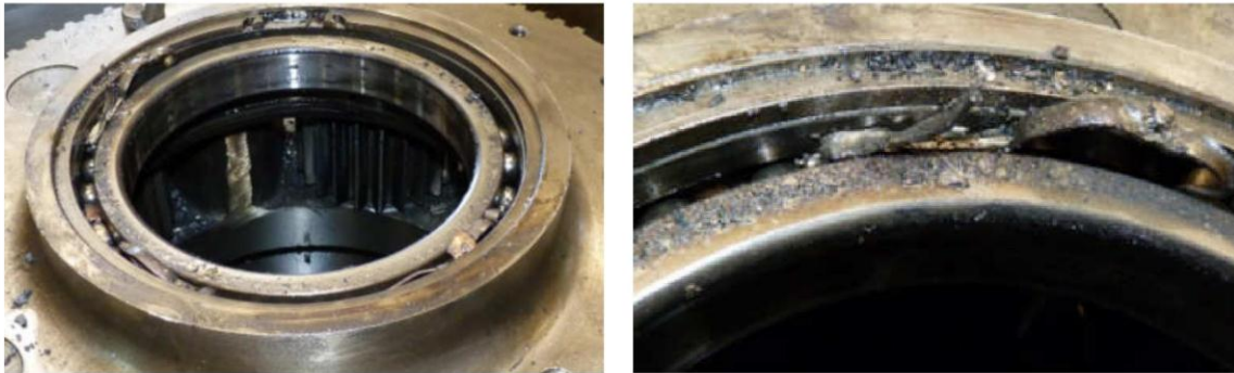
Se muestra el daño observado en el rodamiento N/P 5P-1669.
