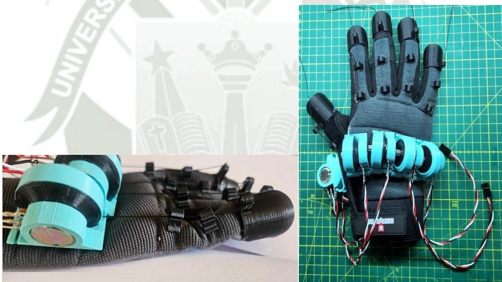
Figura 52.- Integración del sensor resistivo de flexión en el guante
