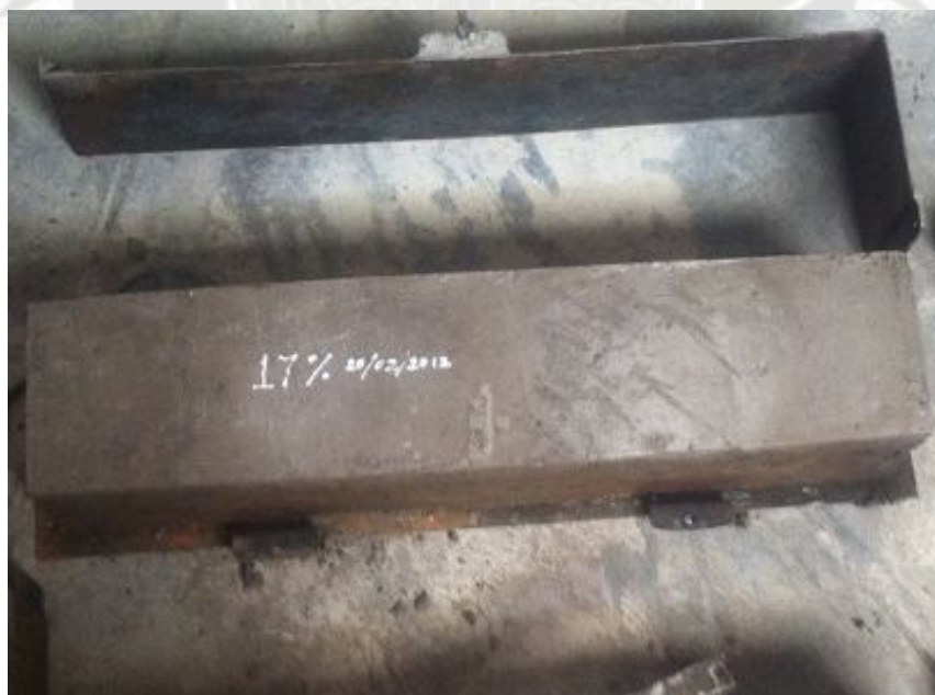
Fig. N°6.14: Desmolde de Vigas refrendadas
