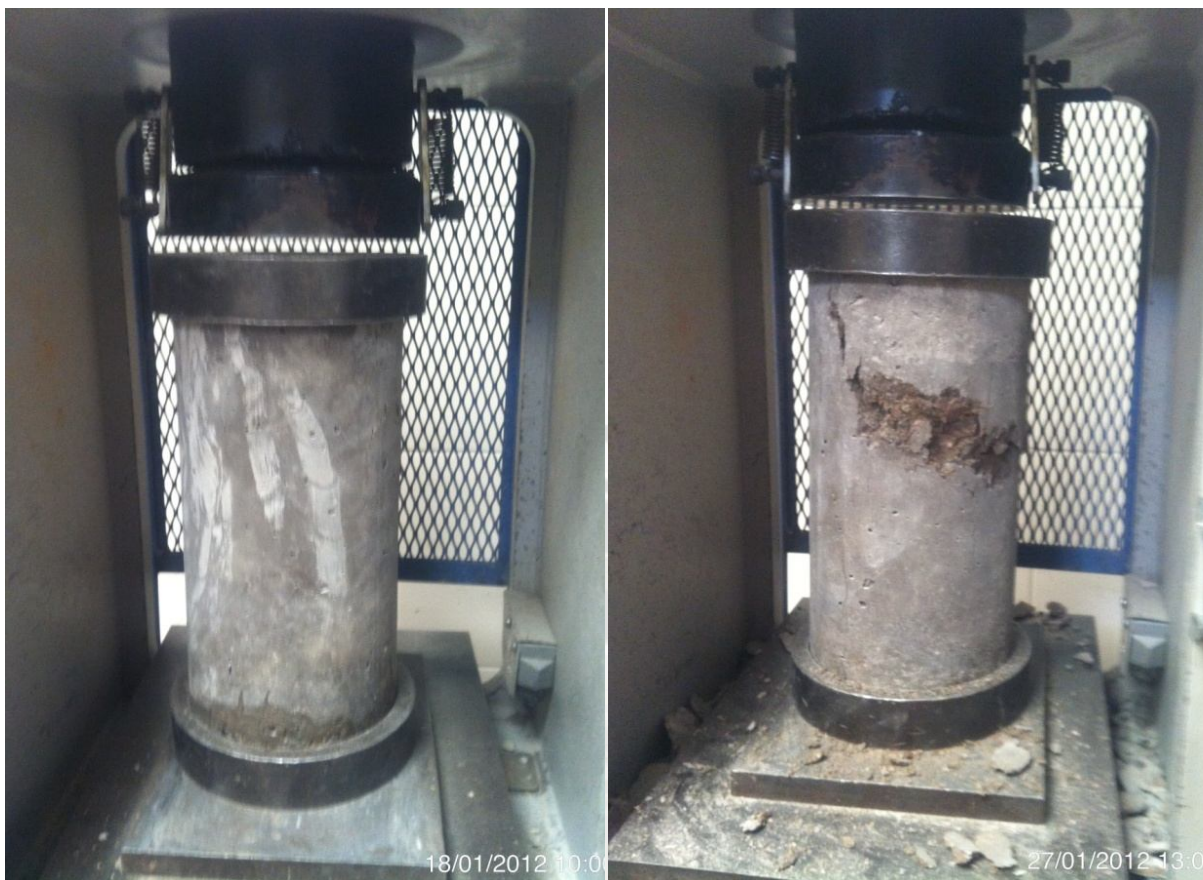
Fig. N°7.2: (a) Probeta lista para ensayarse, (b) Probeta después de la compresión
