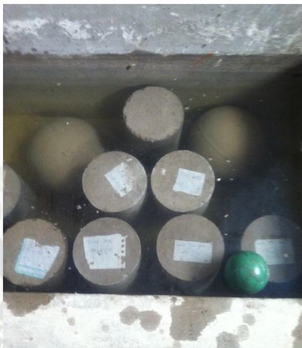
Fig. N°6.10: Poza de curado de briquetas
