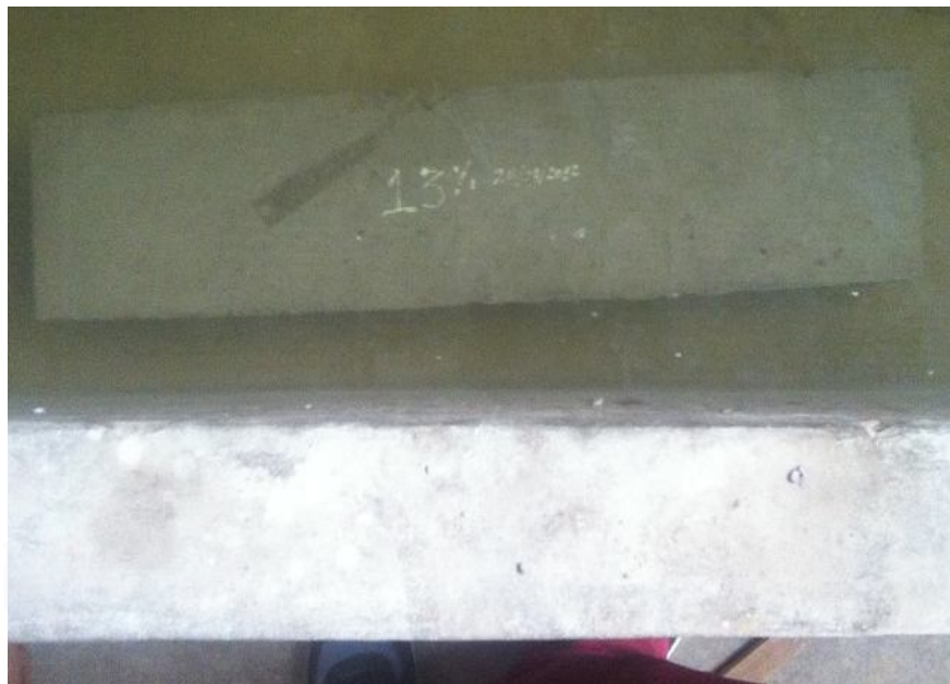
Fig. N°6.15: Poza de curado de viguetas
