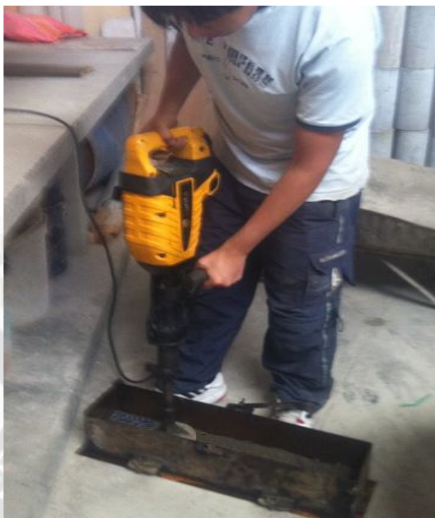
Fig. N°6.13: Aplicación de martillo vibratorio con plancha metálica
