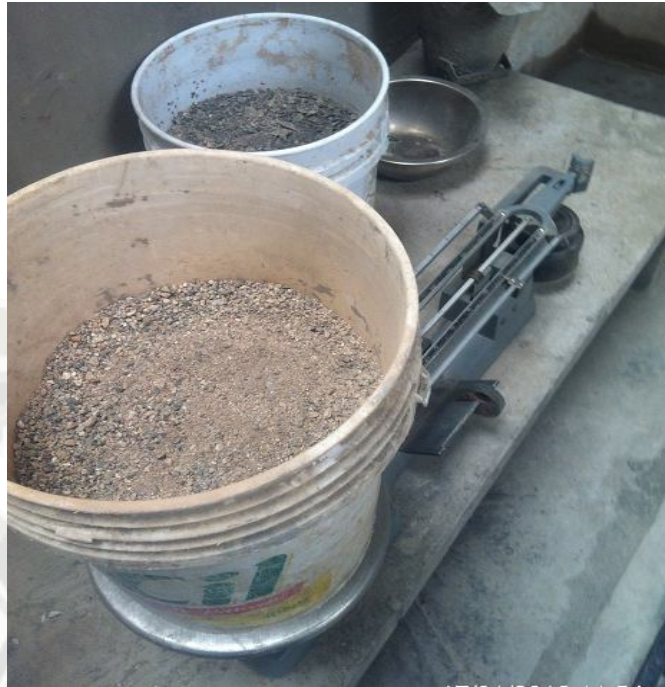
Fig. N°6.6: Pesado de agregado para la dosificación de la mezcla de CCR
