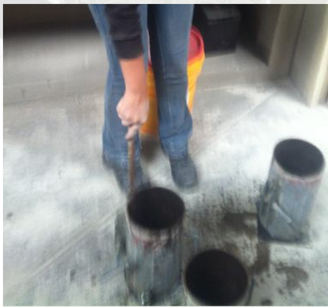
Fig. N°6.5: Preparación de moldes y untados con petróleo
