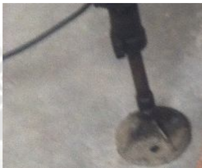
Fig. N°6.4: Placa de apisonamiento circular y eje ajustados al martillo vibratorio
