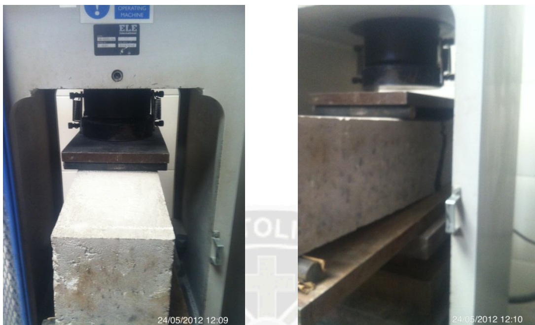
Fig. N°7.5: (a) Vigueta lista para ensayarse, (b) Vigueta después de ensayarse
