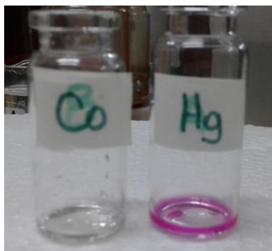
Fig. 27. Fenómeno colorimétrico como respuesta de la molécula sintetizada en presencia de \text{Co}^{2+} y \text{Hg}^{2+} .
