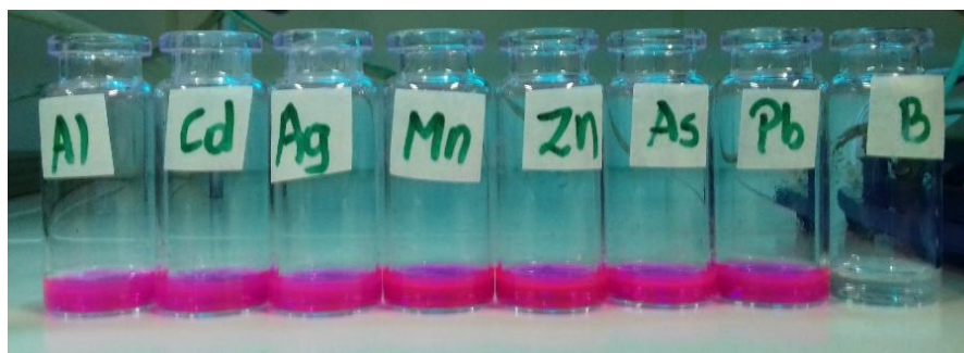
Fig. 28. Batería de metales en presencia de la molécula sintetizada en medio ácido observado en la lámpara UV.
