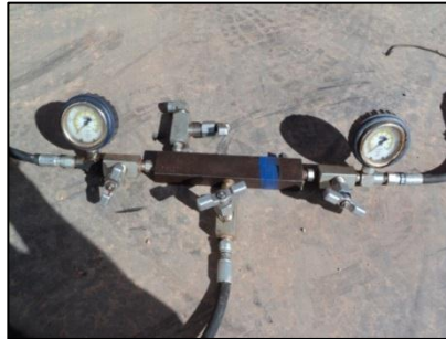
Manifold de carga de Suspensiones Figura N° 93
