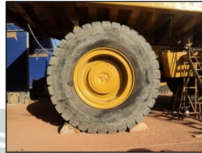
Instalación de tranca-llantas Figura N° 123
