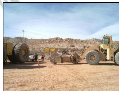
Desmontaje Neumáticos Figura N° 64
