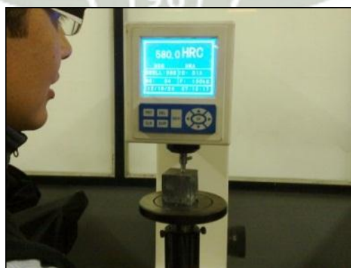
Aplicación de Pre-carga a probeta Fig. N° 46
