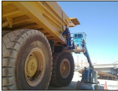
Desmontaje de eslingas Figura N° 114
