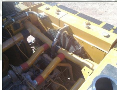
Instalación tuberías de admisión aire Figura N° 87
