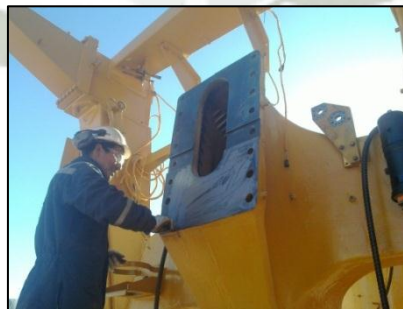
Acondicionamiento de superficie Figura N° 23
