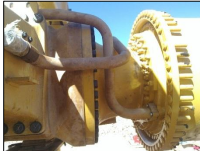
Instalación tuberías de refrigeración Figura N° 46
