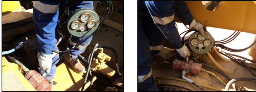
Toma de presiones del Sistema de frenos Figura N° 102 y 103
