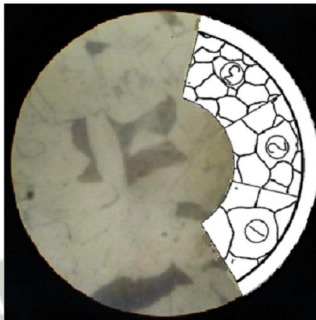
Comparación Probeta N° 1 - Zoom: 100X
