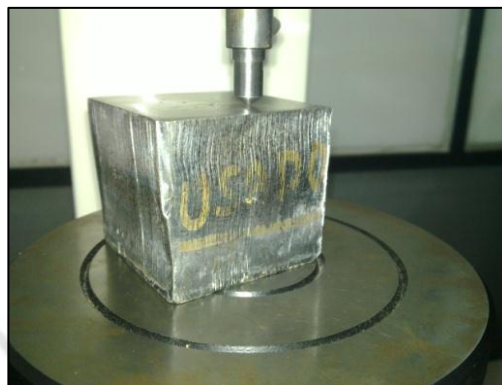
Medición de índice de dureza Probeta N° 1.
