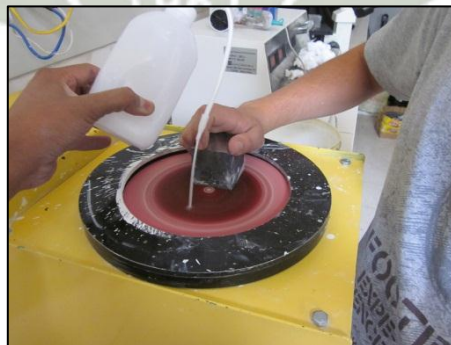
Aplicación de alúmina al proceso de pulido Fig. N° 77
