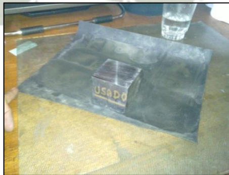
Desbaste de Probetas usando lijar abrasivo Fig. N° 75
