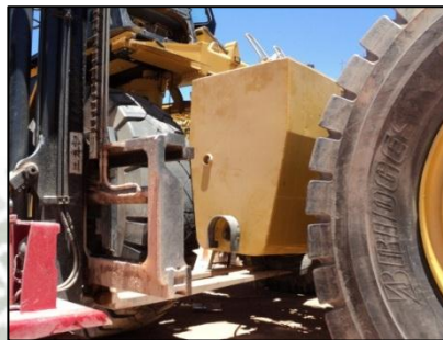
Izaje Tanque de Combustible Figura N°50
