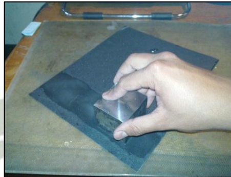
Desbaste lineal de probetas Fig. N° 76
