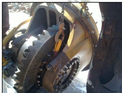
Instalación de eslingas en Diferencial Figura N° 41
