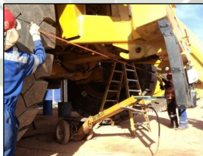
Medición de Divergencia Figura N° 124
