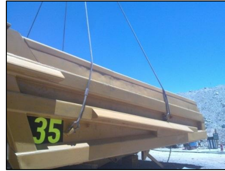
Desnivel de anclajes en tolva Figura N° 5
