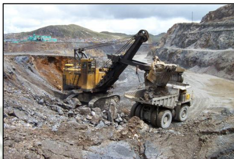
Carguío de material Pala Hidráulica Fig. N° 33
