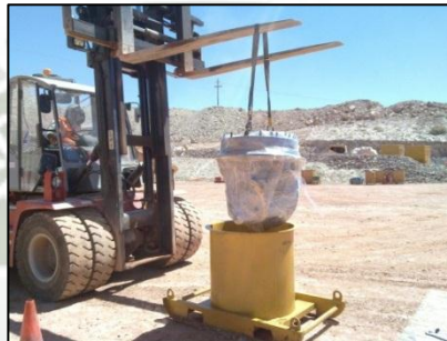
Izaje de Diferencial Figura N° 40
