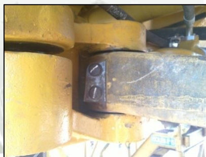
Instalación pernos anclaje Triangulo dirección (Figura N° 30)
