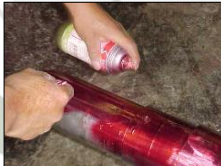
Aplicación de penetrante
