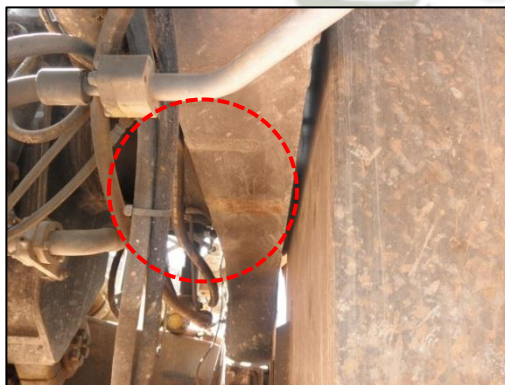
Fisura en larguero izquierdo Fig. N° 4
