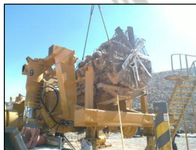
Izaje de Motor Figura N° 39
