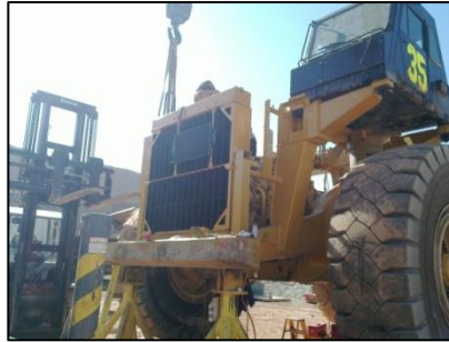
Izaje de Radiador Figura N° 67
