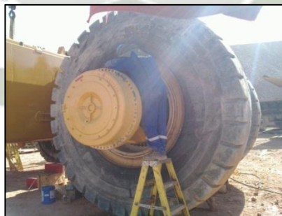
Limpieza de espárragos Figura N° 56
