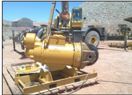
Acople de Transmisión en base Figura N° 47
