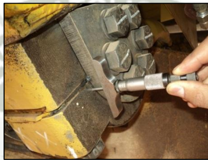
Medición de profundidad Plato Pin Central Figura N° 12
