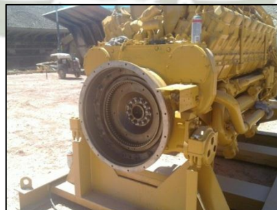
Limpeza de alojamiento de C/T Figura N° 59
