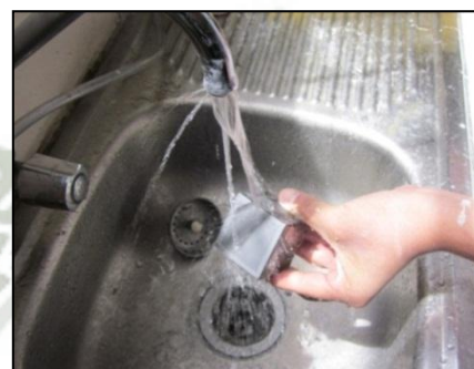
Detenemos el ataque con agua Fig. N° 84
