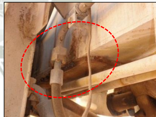
Fisura en larguero derecho Fig. N° 9
