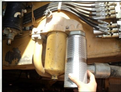
Instalación de filtros hidráulicos Figura N° 90
