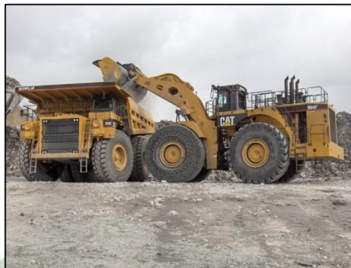
Carguío de material Cargador Frontal 994F
