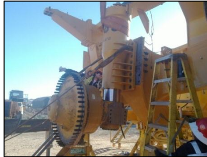
Instalación Susp. Delantera
