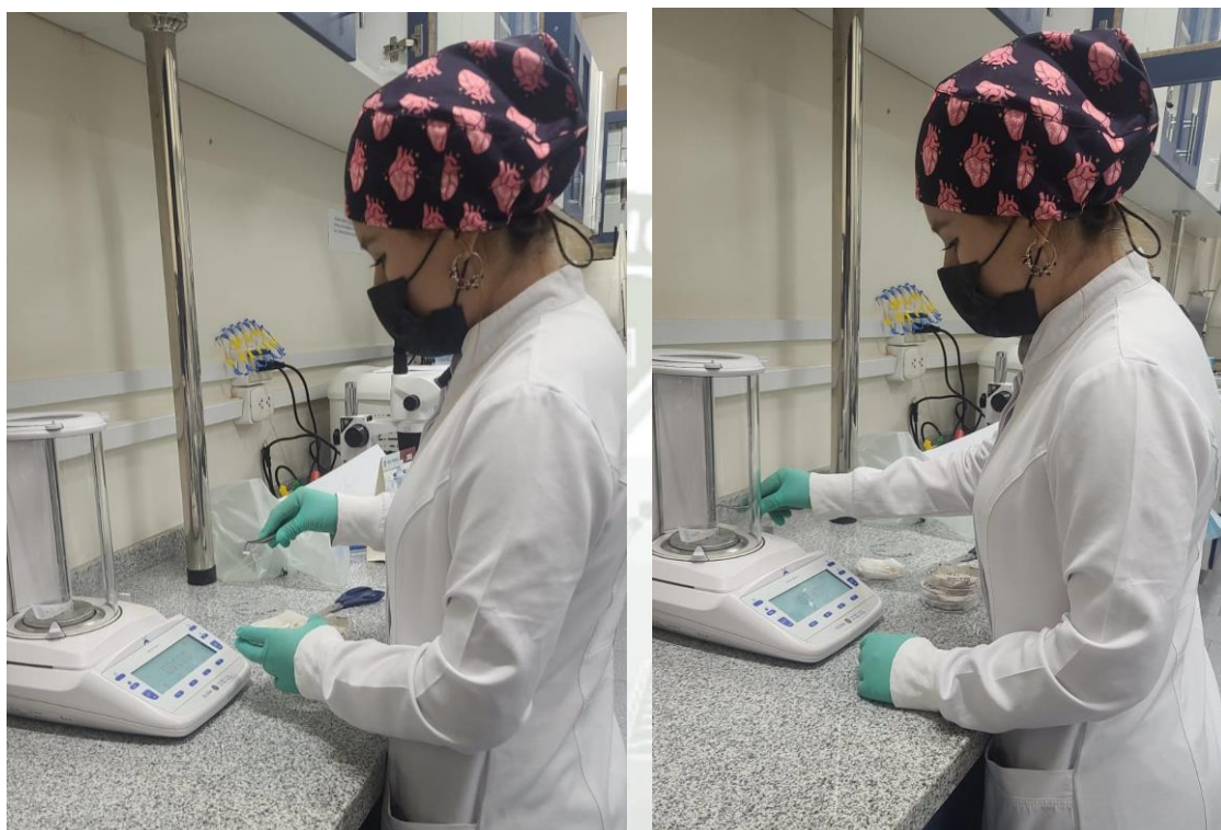
Figura 5 Registro de peso inicial de los discos
