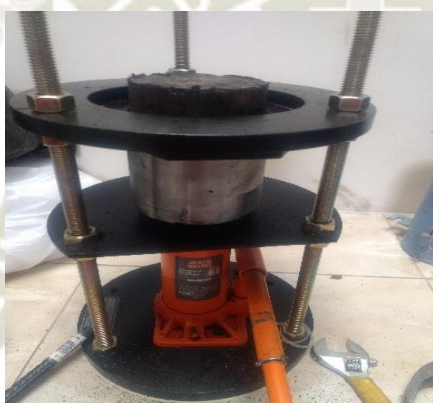
Ilustración 19: Procedimiento de Compresión de probetas con emulsión
