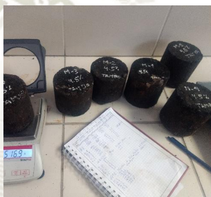
Ilustración 19: Procedimiento de Compresión de probetas con emulsión
