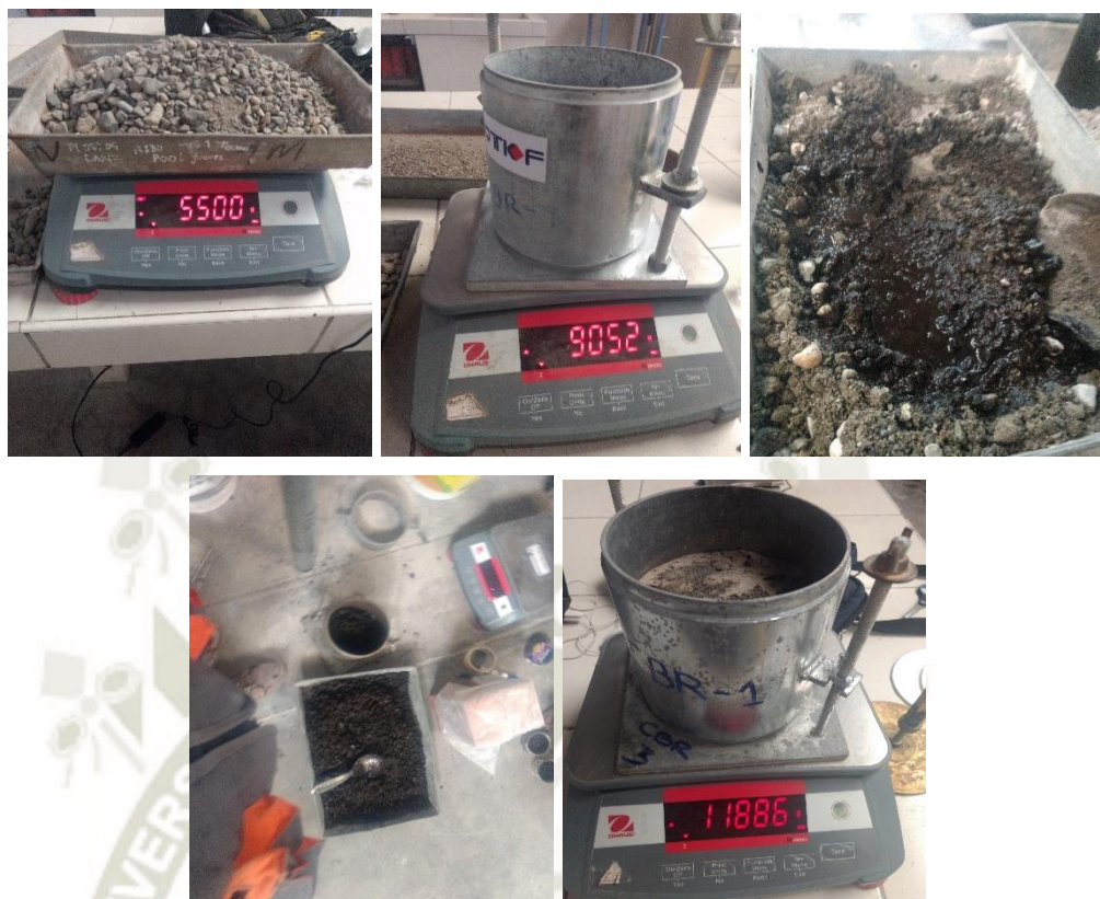
Ilustración 18: Procedimiento de ensayo de CBR con emulsión asfáltica CSS-1h
