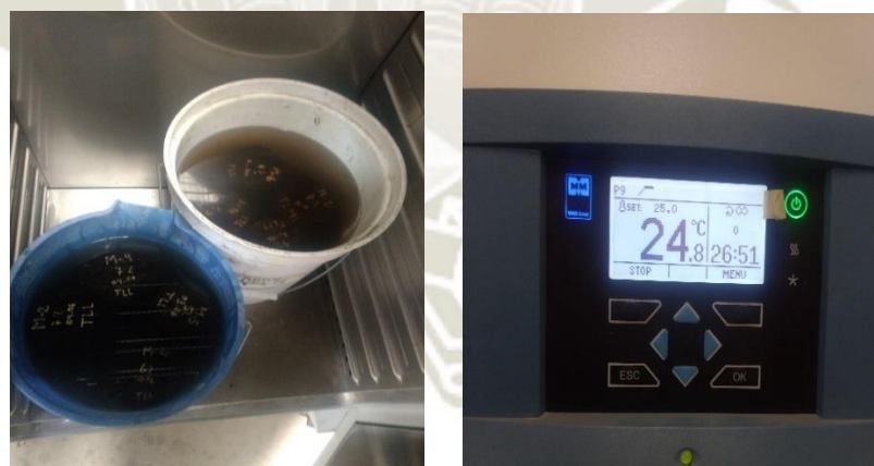
Ilustración 21: Probetas curadas a 25^\circ\text{C} inmersas en agua
