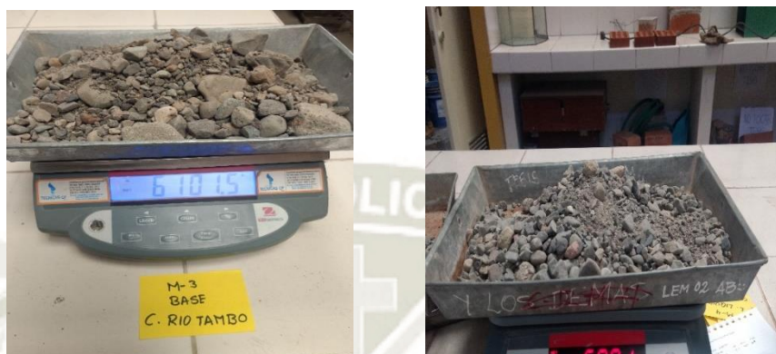
Ilustración 12: Procedimiento de ensayo de humedad
