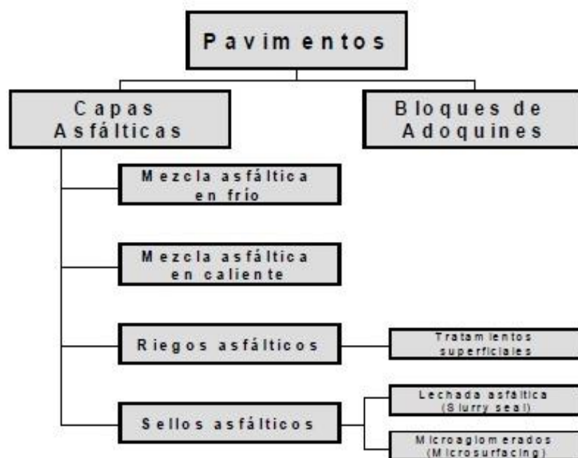
Ilustración 1: Tipos de superficies de rodadura en pavimentos flexibles
