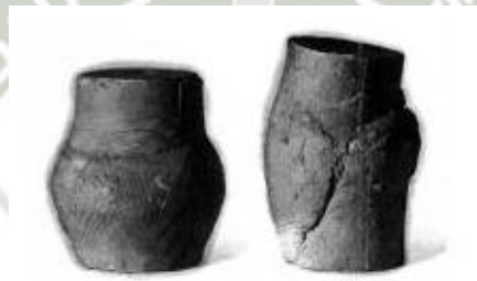
Figura 3.26. Especímenes después de la falla en compresión simple
