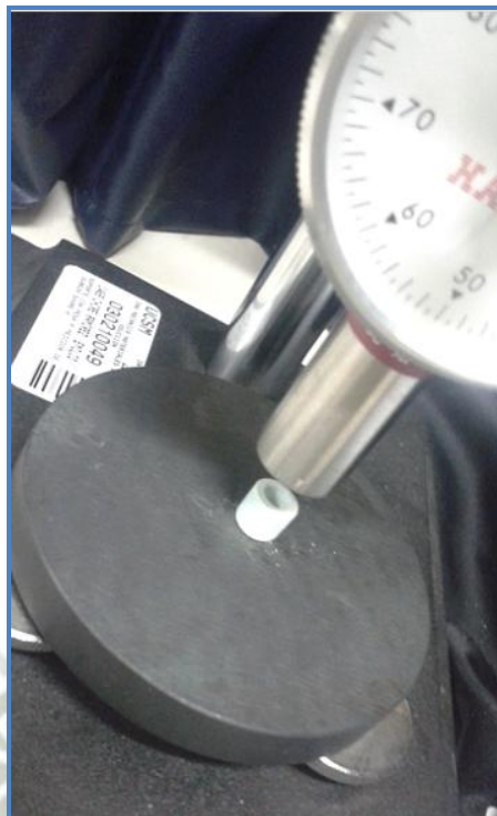
Figura 3.27. Medición de la dureza Shore A.
