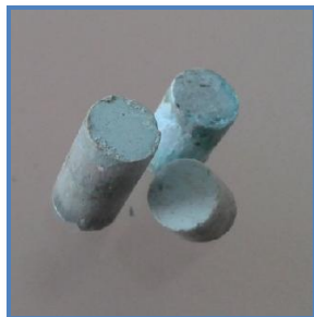
Figura 4.3: Fotografía de los cilindros obtenidos por moldeo por compresión después de la impregnación con \text{CuNO}_3 .
