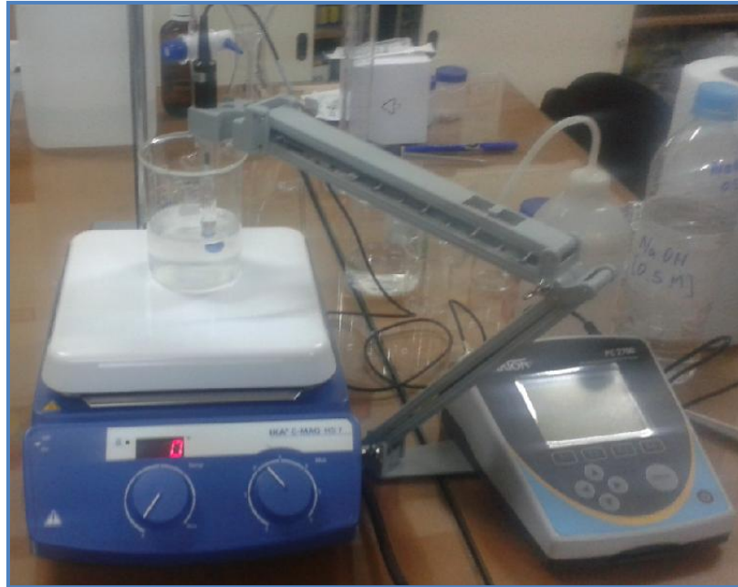
Figura 4.9: Sistema Armado para la Valoración Potenciométrica del \text{Al}_2(\text{SO}_4)_3
