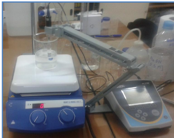
Figura 3.21: Sistema Armado para la Valoración Potenciométrica del \text{Al}_2(\text{SO}_4)_3
