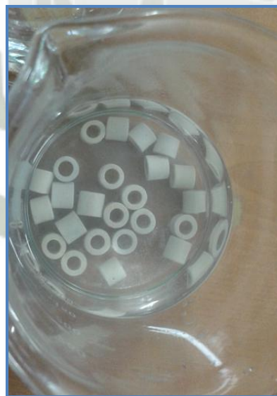
Figura 4.6 Núcleo Cerámico sumergido en la solución de HF al 20 %.
