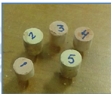
Figura 4.4: Fotografía de los cilindros obtenidos por moldeo por compresión después de la calcinación a 700 °C.
