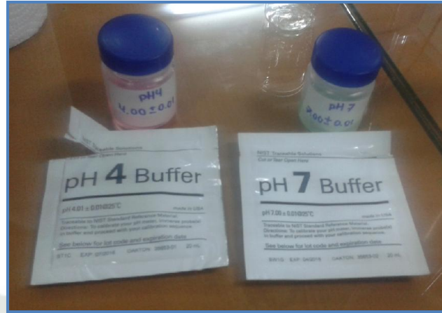
Figura 3.23: Soluciones Buffer usadas para calibrar el Potenciómetro.
