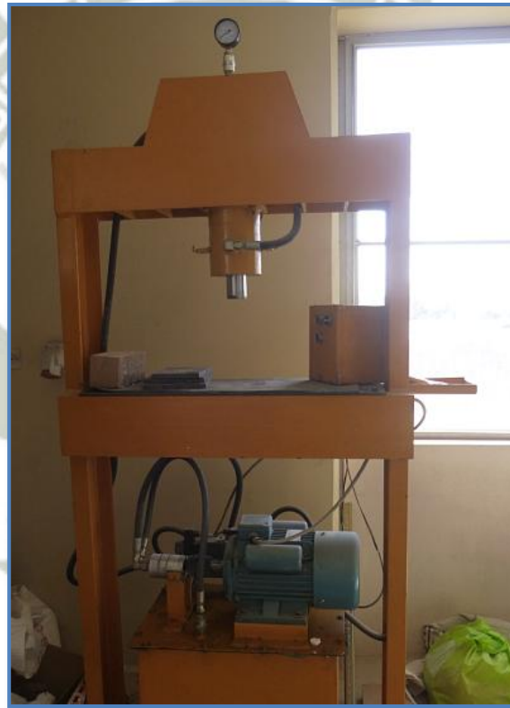
Figura 4.2: Fotografía de la prensa usada para el moldeo por compresión (Equipo de los Laboratorios de Ingeniería de Materiales - UNSA)
