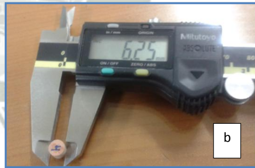
Figura 4.18: medición de las probetas a) medición de la Masa b) medición del Diámetro
