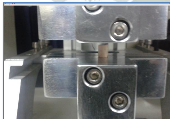
Figura 4.11 Imagen de la probeta colocada en el porta muestra antes del ensayo de compresión
