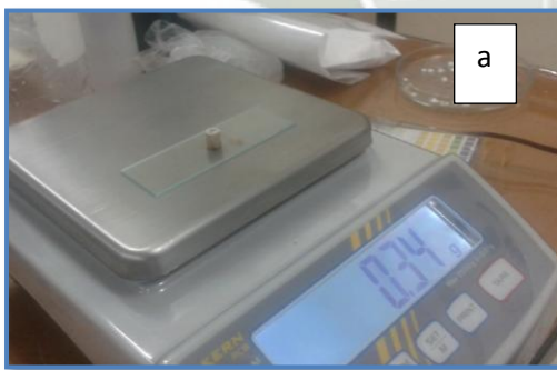
Figura 4.18: medición de las probetas a) medición de la Masa b) medición del Diámetro
