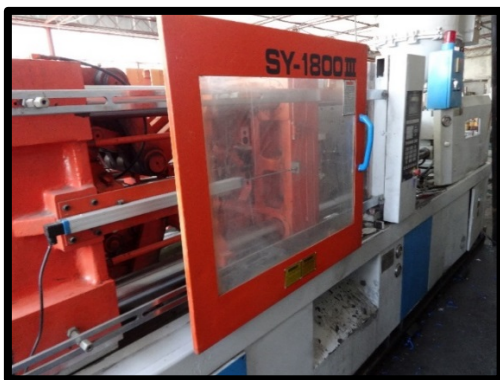
Foto N° 1. Inyectora mecánica 11INM01.
