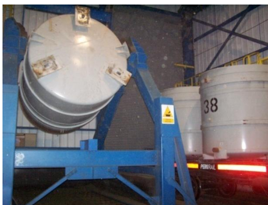
Imagen 19: Volteo de contenedor por gravedad.
