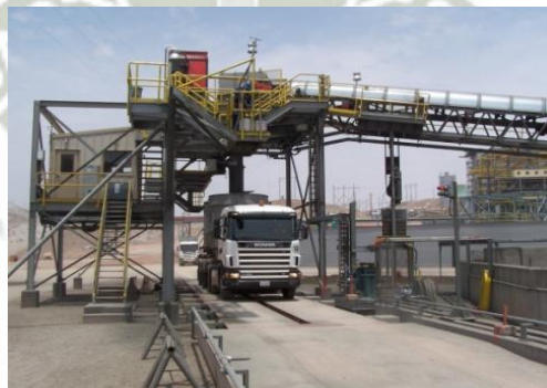
Imagen 11: Faja de Traslado y plataforma de apertura de tapas
