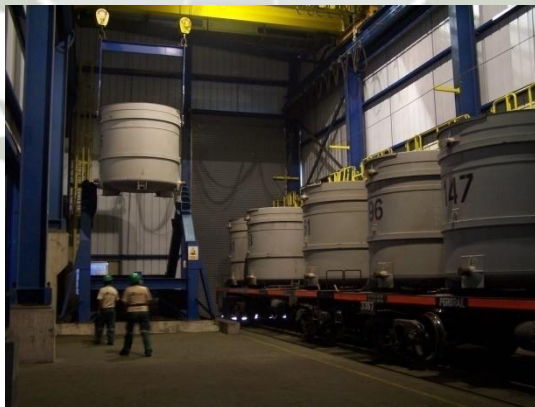
Imagen 18: Izaje y traslado de contenedor hacia puente de volteo.
