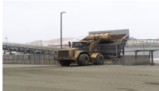
Imagen 10: Chute de alimentación de Concentrado e Inicio de faja
