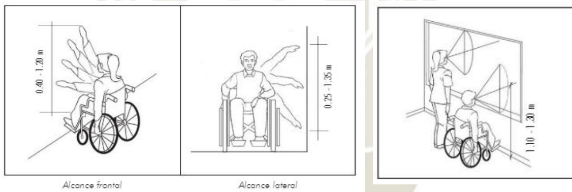
Gráfico N° 21: Requerimientos para superar dificultades de alcance / FUENTE: Discapacidad y diseño accesible, diagramación: Arq. Jaime huerta peralta, Edición propia
