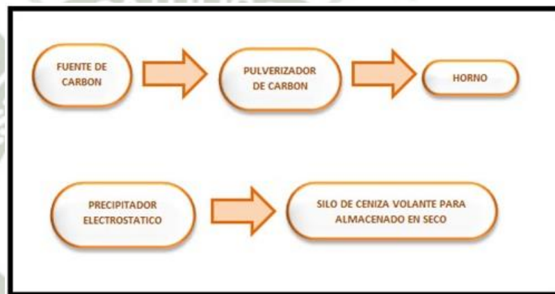
Figura 2.1 Proceso de Obtención de la Ceniza Volante.
