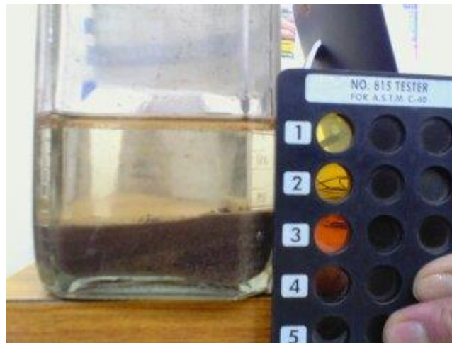
Figura 3. 3 Vista de la comparación de impurezas orgánicas con del Patrón Gardner #11 para el agregado fino.
