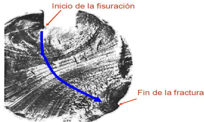
Fig. 3.3 Inicio y fin de la fractura por fatiga
