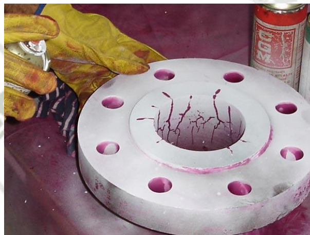
Fig. 4.2 Ensayo líquidos penetrantes
