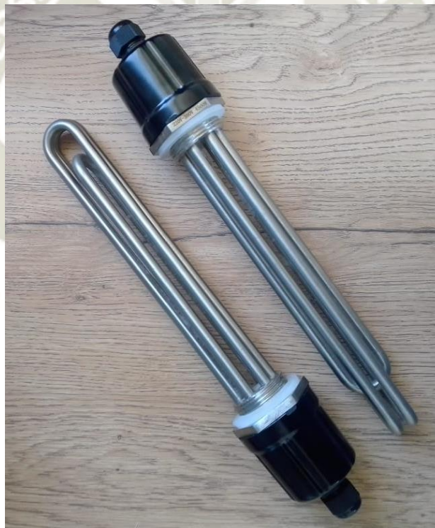
Fig. 25. Resistencias de inmersión 4.5kW c/u
