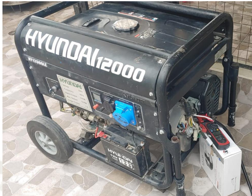
Fig. 90. Grupo electrógeno para funcionamiento de planta piloto
