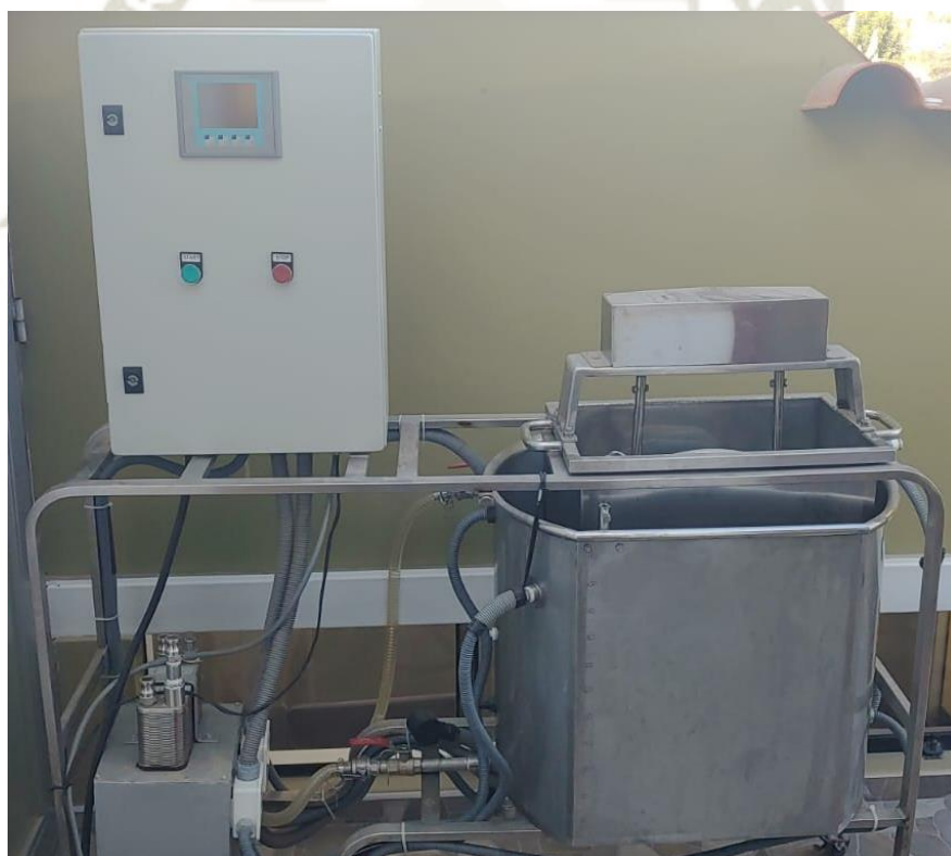
Fig. 35. Planta de maceración armada
