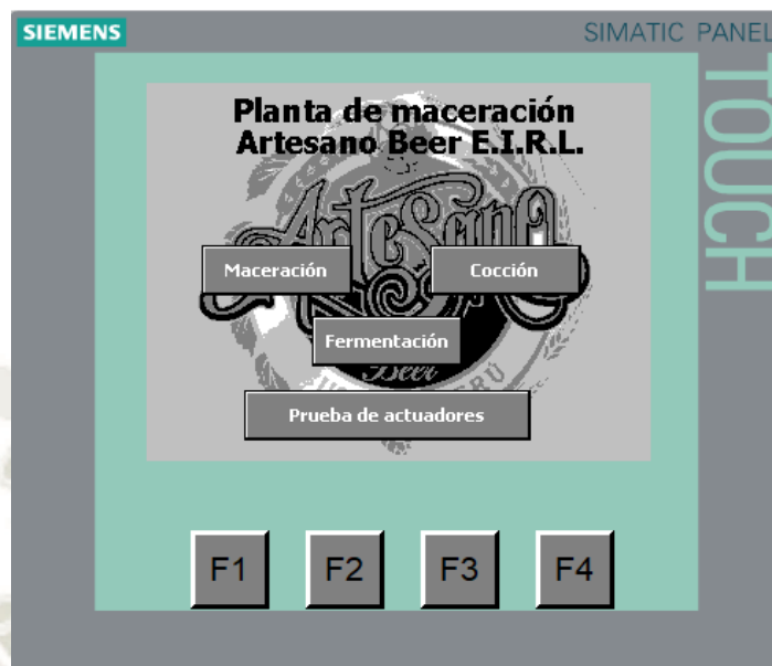
Fig. 82. HMI- Vista de Screen planta de maceración en START
