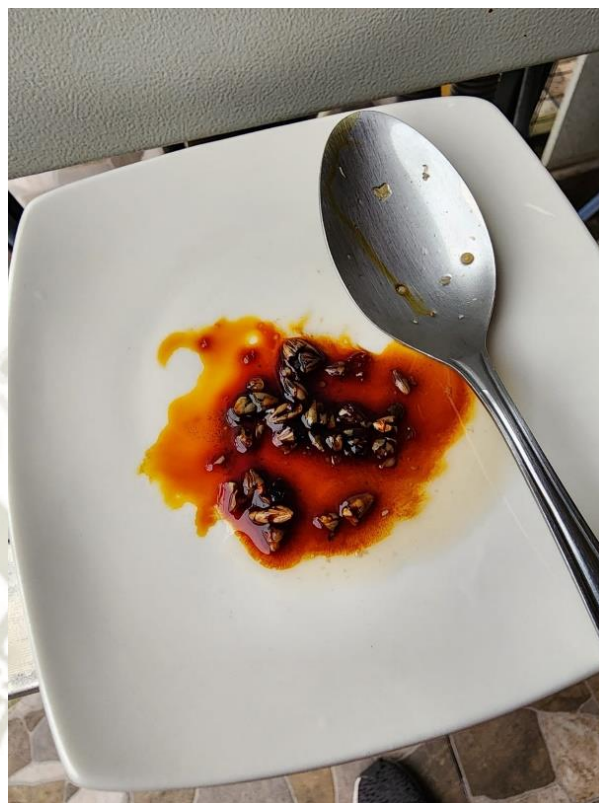
Fig. 95. Prueba de yodo inicial al mosto
