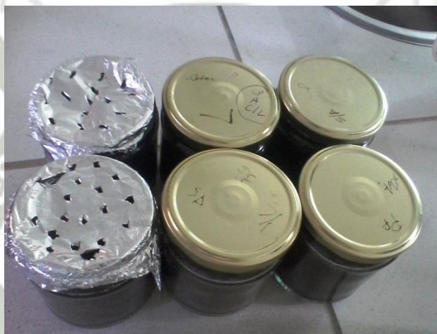
Figura 22. Contenedores de suelo artificial con pesticidas protegidos de la luz.
