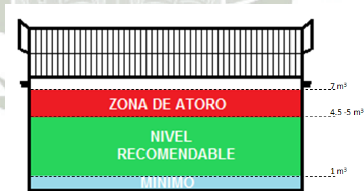
Ilustración 17- Niveles Cajón Alimentador Terex 390
