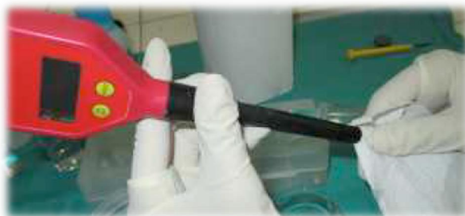
FOTO N° 3 Secado el electrodo con papel absorbente después de cada lavado.
