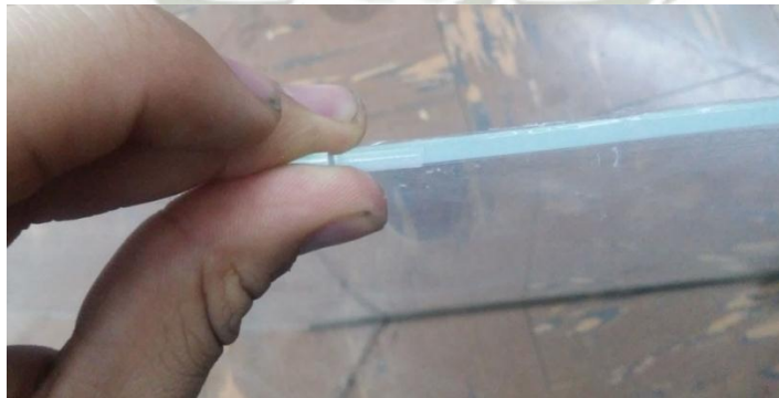
Fig. 3.24 Espesor de plancha elegida: 4 mm
