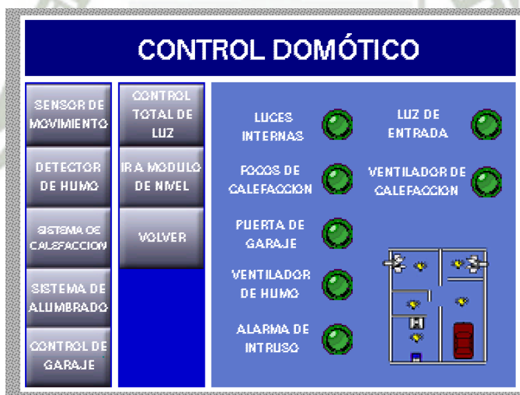
Fig. 4.19 Panel de control domótico.
