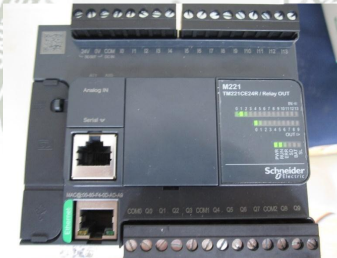
Fig. 4.11 PLC ya cargado con el programa detectando entradas y salidas.
