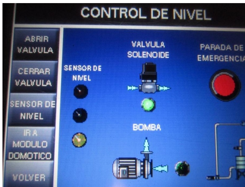
Fig. 5.26 Luego del llenado del tanque, la respuesta del HMI a la activación de la válvula solenoide.
