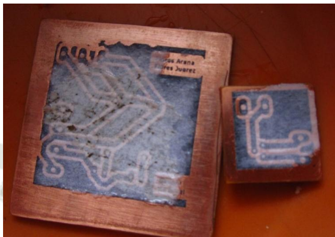
Fig. 3.58 Resultado luego de haber pasado por el ácido las placas.
