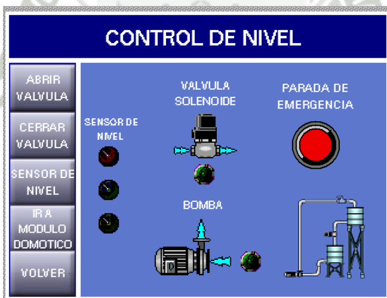
Fig. 4.25 Panel de control de nivel de tanque.
