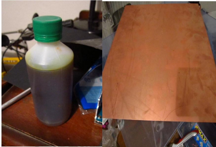
Fig. 3.56 Ácido para el quemado de las placas y la placa donde se quemarán los circuitos.
