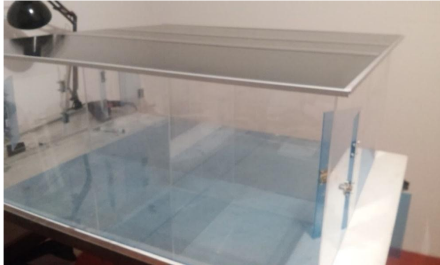
Fig. 3.43 Colocación de los perfiles en U y en H para el techo de la vivienda
