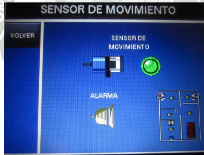
Fig. 5.24 Respuesta del HMI a alarma de intruso encendida.
