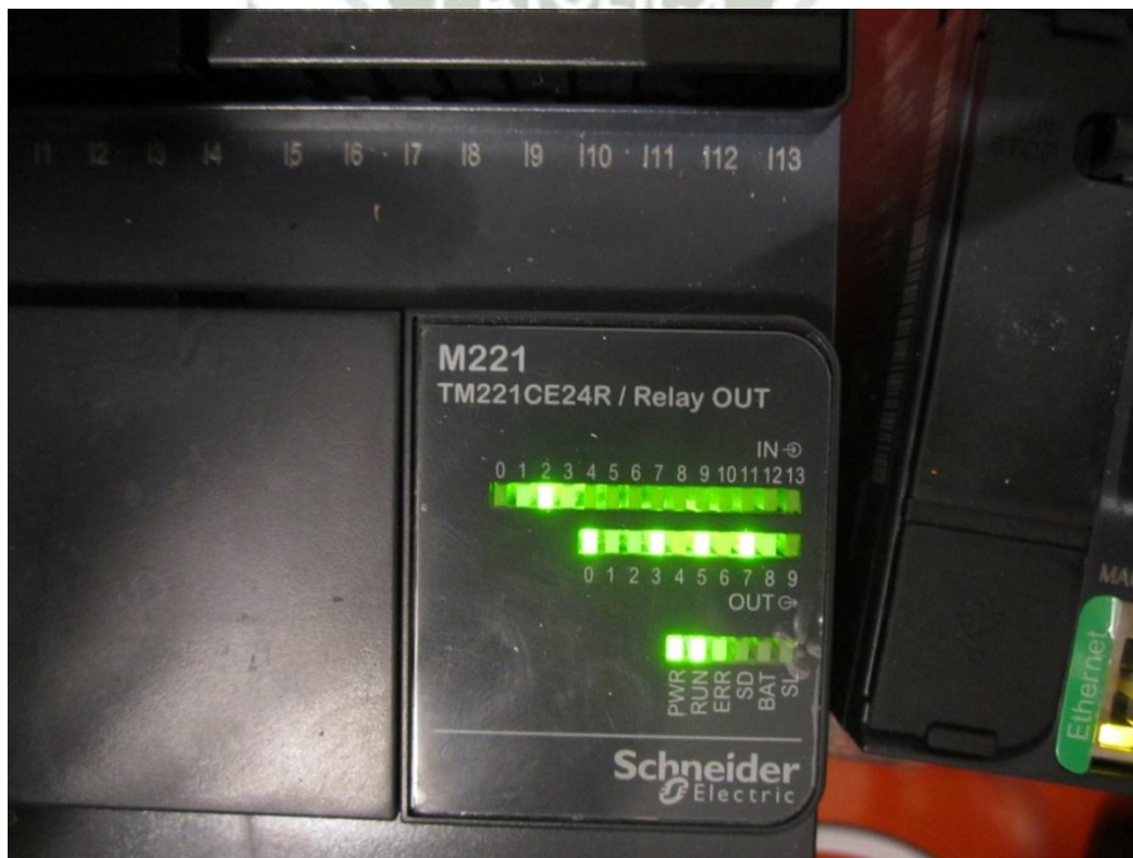
Fig. 5.11 Respuesta del PLC a la activación del sensor
