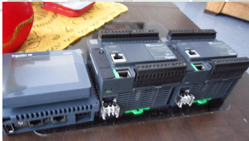
Fig. 3.85 Vista de los PLC's y el HMI.
