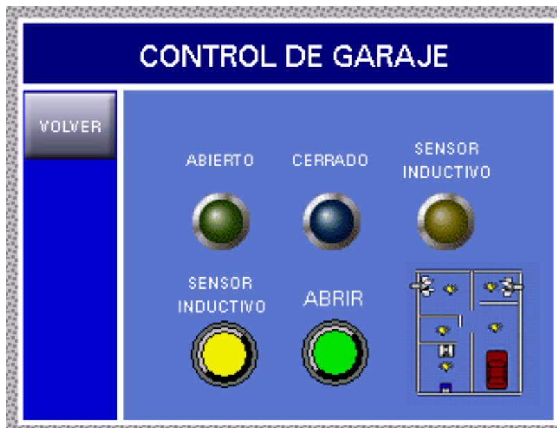
Fig. 4.24 Panel de control de la puerta de garaje.
