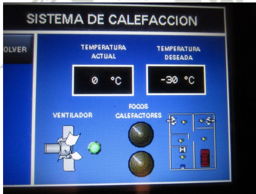
Fig. 5.20 Respuesta del HMI al sensor LM35 con temperaturas altas.
