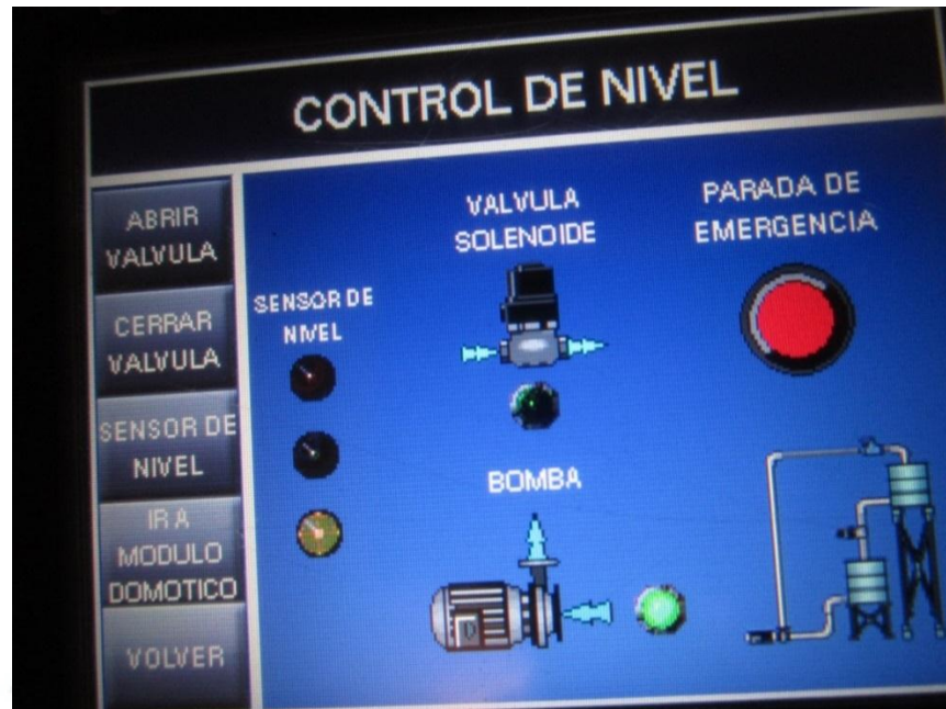
Fig. 5.25 Respuesta del HMI a la activación de la bomba.
