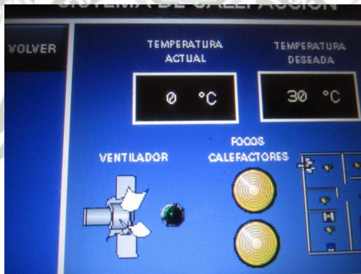
Fig. 5.16 Respuesta del HMI al sensor LM35 con temperatura bajas
