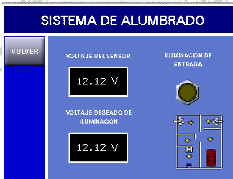
Fig. 4.23 Panel de control del sistema de alumbrado.
