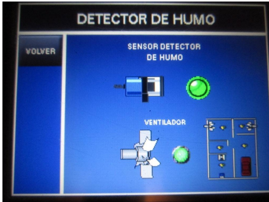
Fig. 5.12 Respuesta del HMI a la activación del sensor
