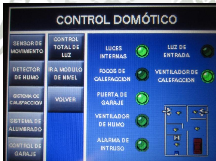
Fig. 5.5 Activando las luces de entrada en el HMI
