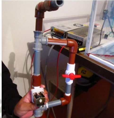
Fig. 3.81 Armado de la tubería que conectará los dos tanques con la válvula solenoide.
