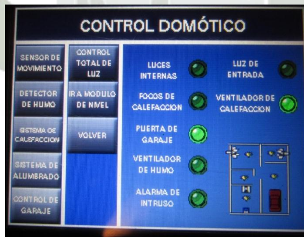
Fig. 5.22 Respuesta del HMI a alarma de intruso apagada.
