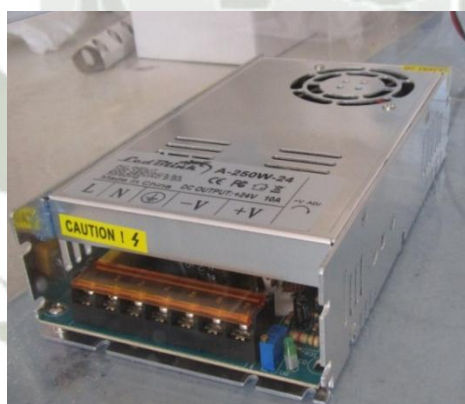
Fig. 3.61 Elección de la fuente de 24 v
