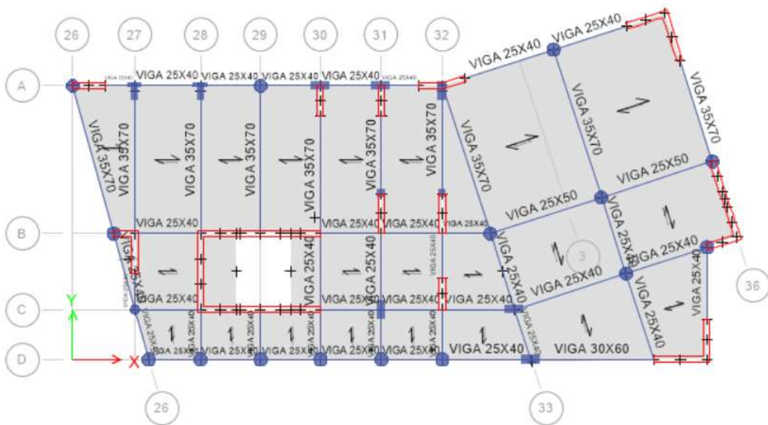
FIGURA N° 17 Estructuración Etabs Bloque 4 (Fuente Propia)
