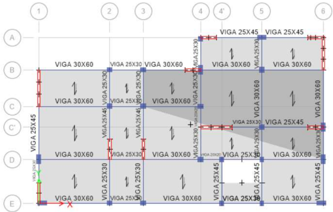
FIGURA N° 14 Estructuración Etabs Bloque 1 (Fuente Propia)
