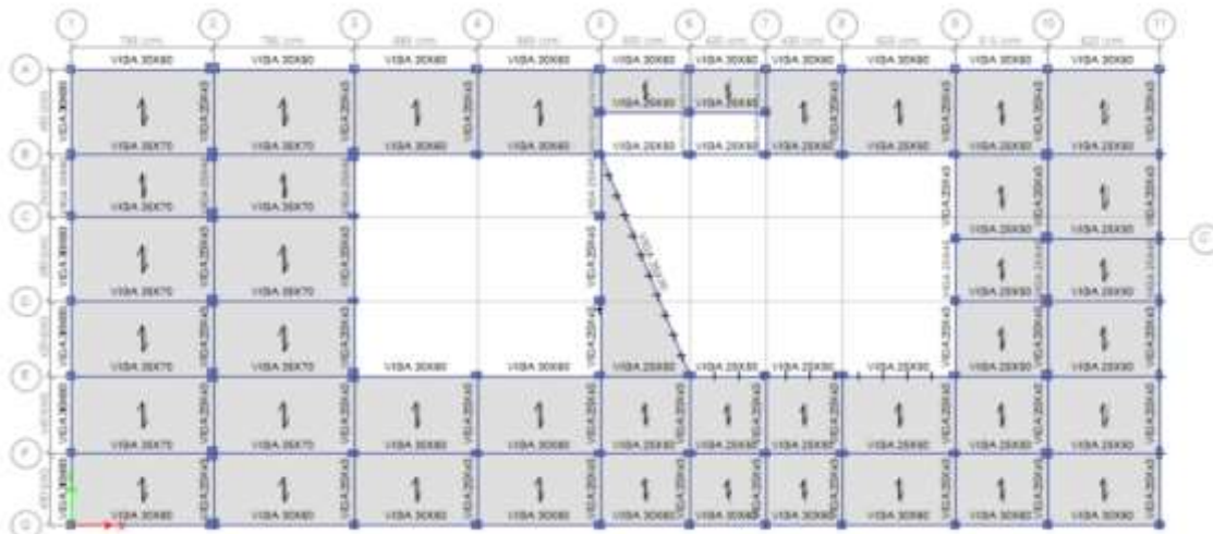
FIGURA N° 18 Estructuración Etabs Bloque 5 (Fuente Propia)
