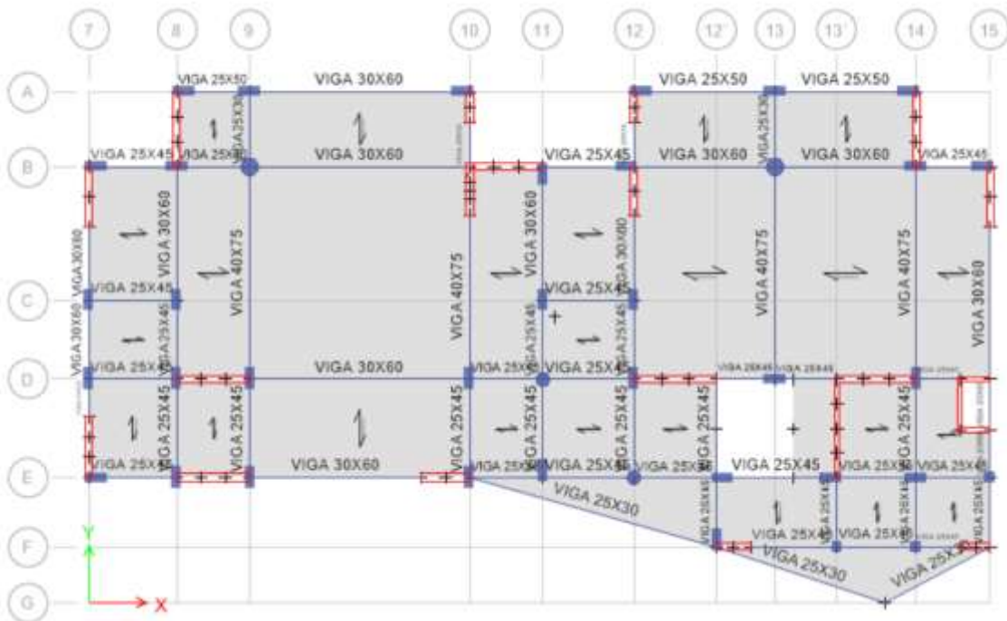
FIGURA N° 15 Estructuración Etabs Bloque 2 (Fuente Propia)
