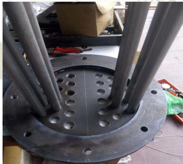
Figura 33. Instalación de haz de tubos en base circular
