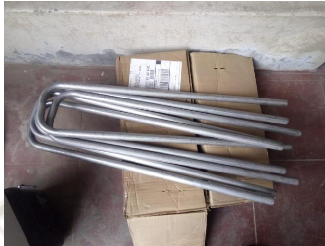
Figura 32. Haz de tubos para línea de vapor y condensado
