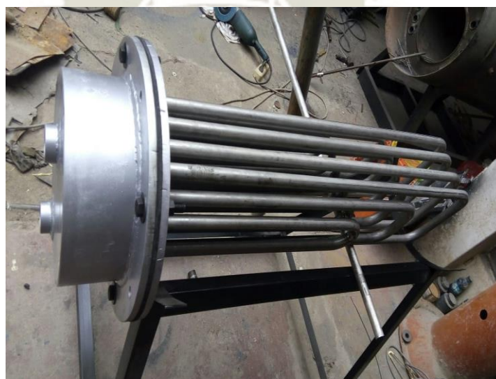
Figura 35. Instalación de cabezal y haz de tubos para línea de vapor
