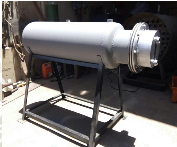
Figura 36. Instalación de intercambiador de calor de coraza y tubos
