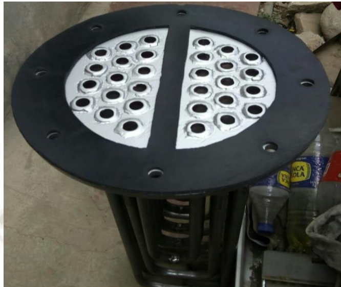
Figura 34. Haz de tubos soldados en base circular
