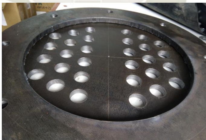
Figura 31. Perforación de la base para haz de tubos
