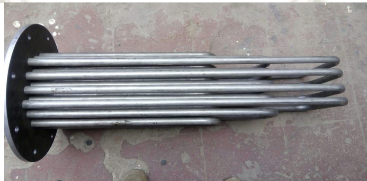
Figura 39. Tubos del intercambiador de calor
