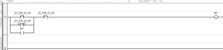
Fig. 6.17. Circuito de alimentación en lenguaje Ladder.
