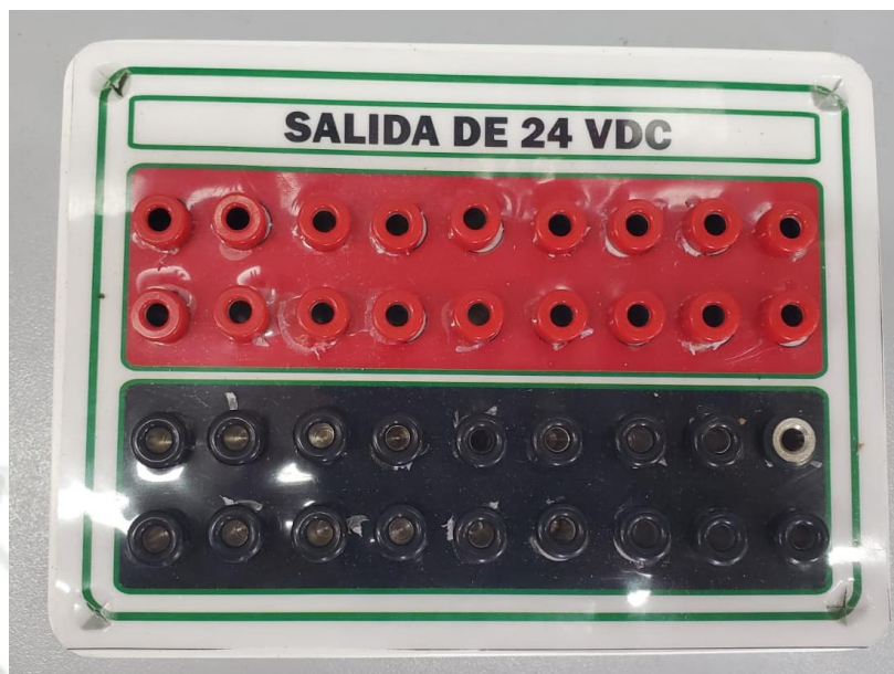
Fig. 68. Caja de distribución de la salida de 24VDC.
