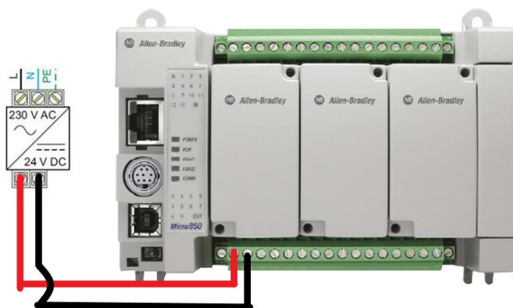
Fig. 2.4. Diagrama de conexión entre la fuente de alimentación y el PLC.
