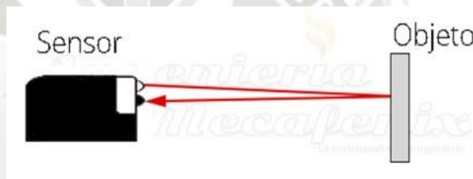
Fig. 10. Sensor óptico difuso – reflectivo. [10]
