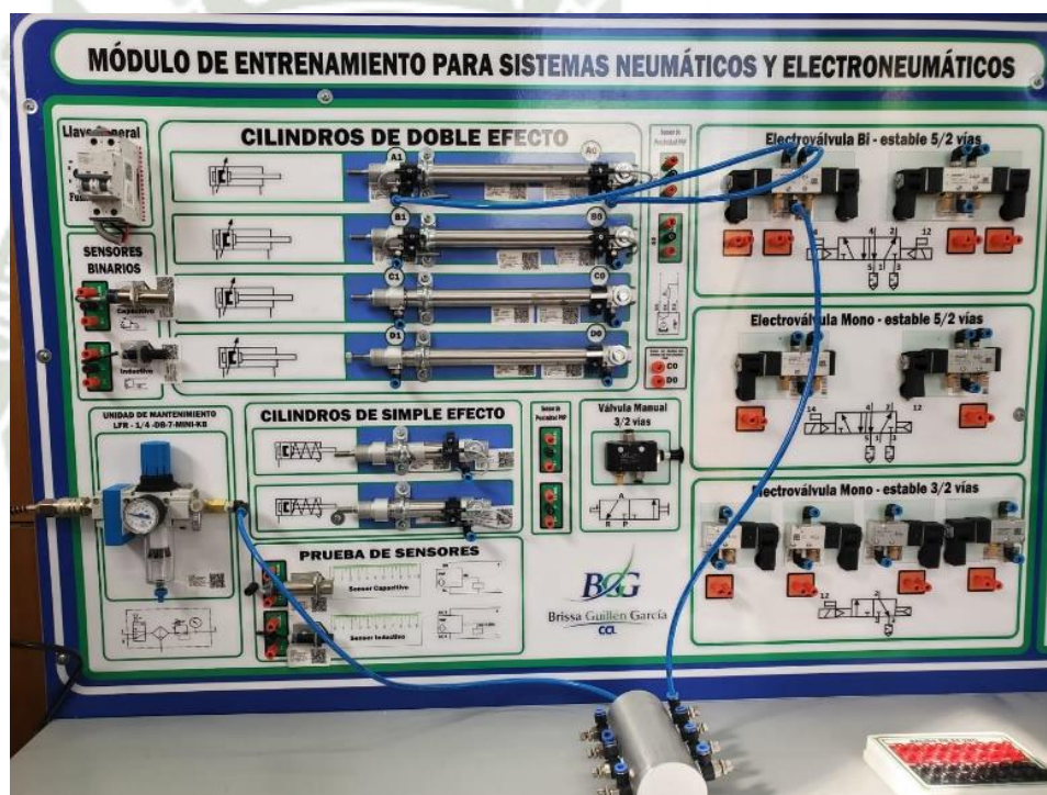
Fig. 4.30. Implementación del circuito de mando para un cilindro de doble efecto con válvulas biestables 5/2.
