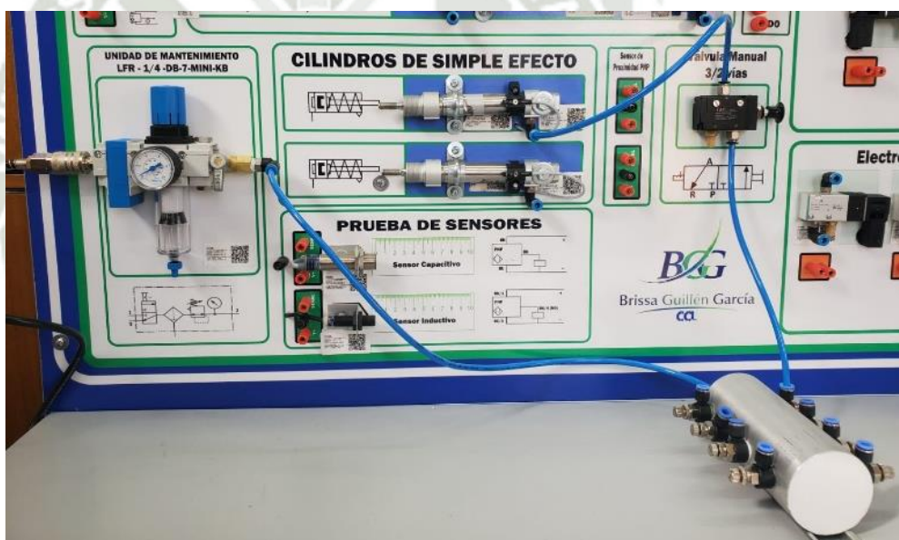
Fig. 4.23. Implementación del circuito de mando para un cilindro de simple efecto.
