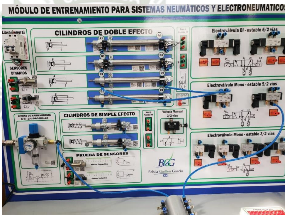
Fig. 4.28. Implementación del circuito de mando para un cilindro de doble efecto con válvulas monoestables 5/2.
