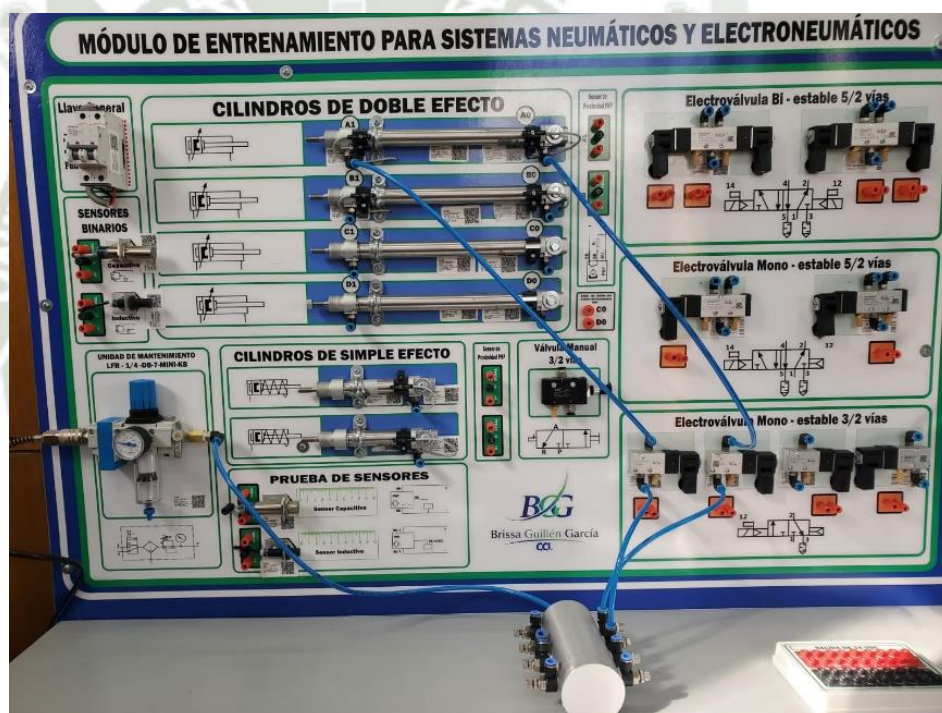
Fig. 4.32. Implementación del circuito de mando para un cilindro de doble efecto con válvulas monoestables 3/2.
