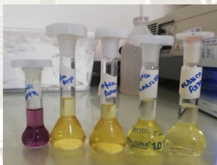
FIGURA 28: Extractos metanólicos de marañón en presencia de solución DPPH
