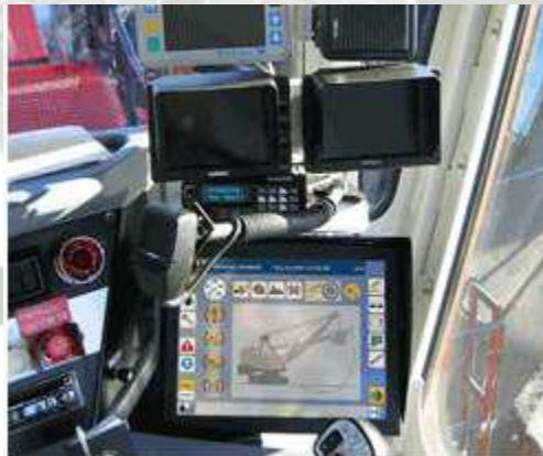
Fig. 6.38 Cabina del operador – Touch panel
