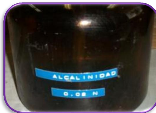
Fig. 29. Solución de ácido sulfúrico 0.02N.
