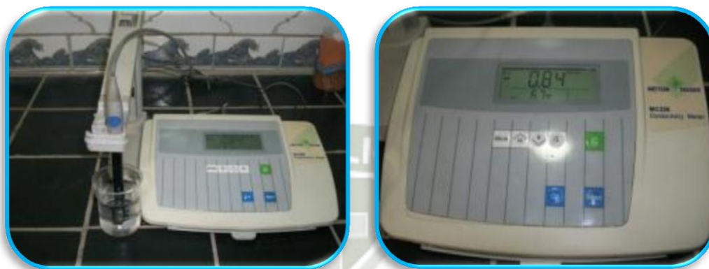
Fig. 24y 25. Calibración del conductímetro.
