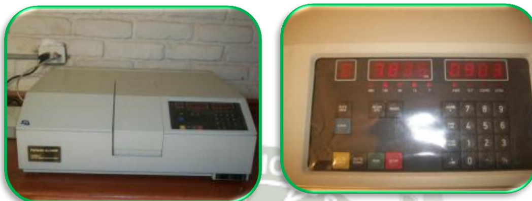
Fig. 41 y 42. Espectrofotómetro UV-VIS 190-900 utilizado para determinar hierro.
