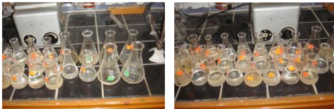
Fig.34 y 35. Erlenmeyer con muestras de agua para determinar dureza.
