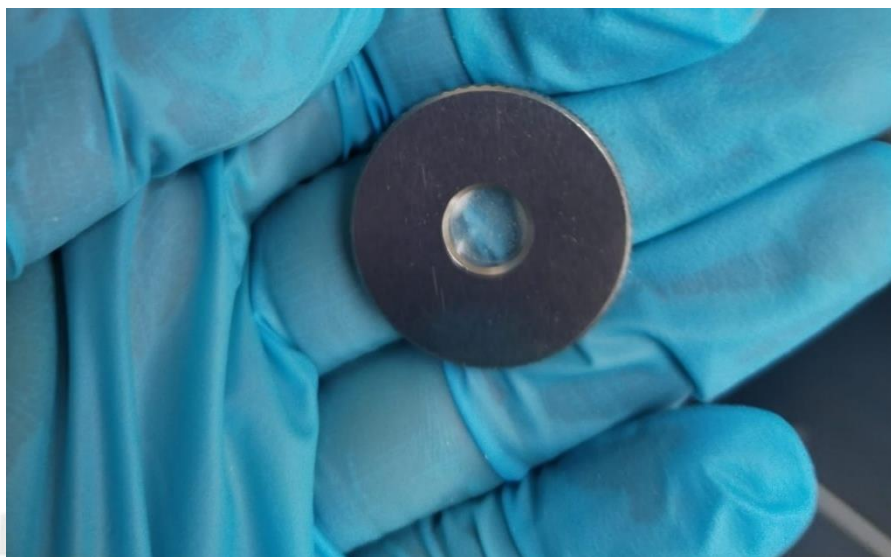
Figura 21: Formación de la pastilla o Pellet.
