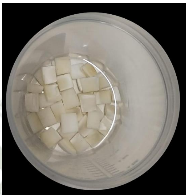
Figura 11: Aplicación de Ácido Láctico durante 72 horas, en estufa a temperatura de 37°C.
