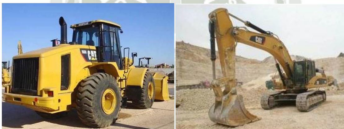
Fotografía N° 5 Equipos de carguío: CF 966H y excavadora 330DL
