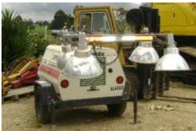
Fotografía N° 10: Torre de iluminación Terex Amida
