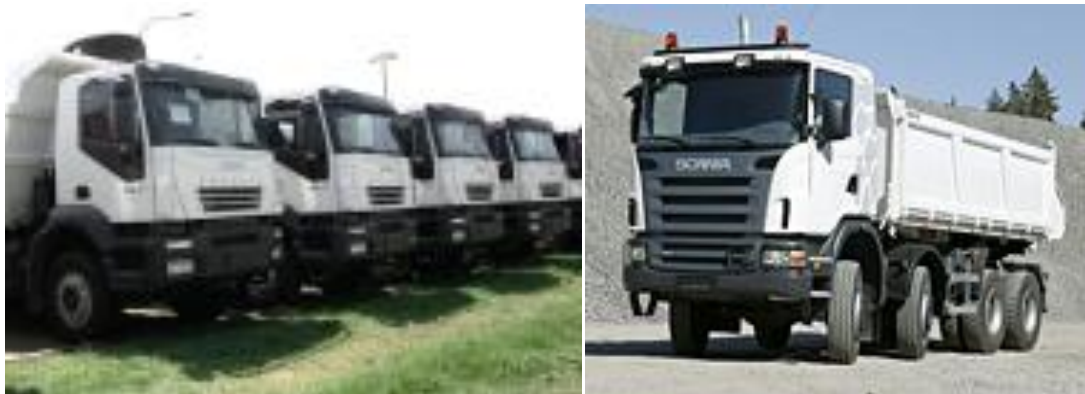
Fotografía N° 7: Equipos de acarreo Iveco de 15 m 3 y Scania de 20 m 3
