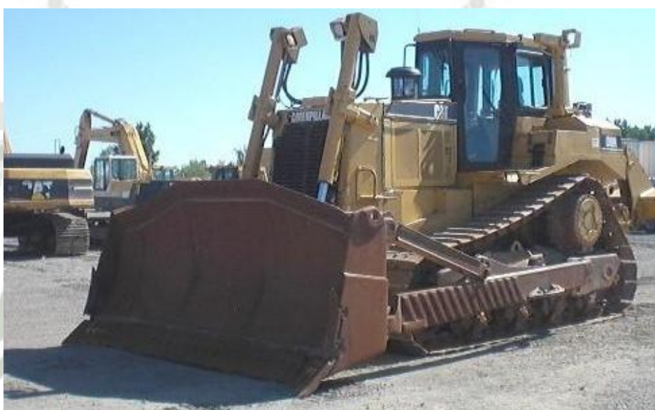
Fotografía N° 8: TRACTOR ORUGA CATERPILLAR D8R
