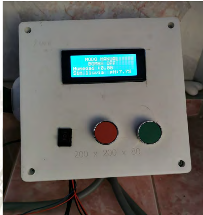
Figura 30. Prototipo sistema de riego automatizado
