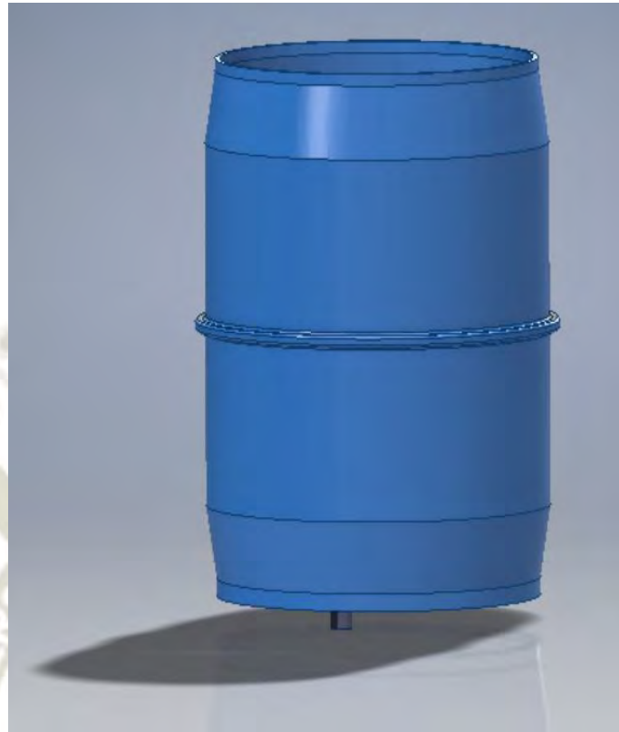
Figura 18. Tanque primario de almacenado de agua
