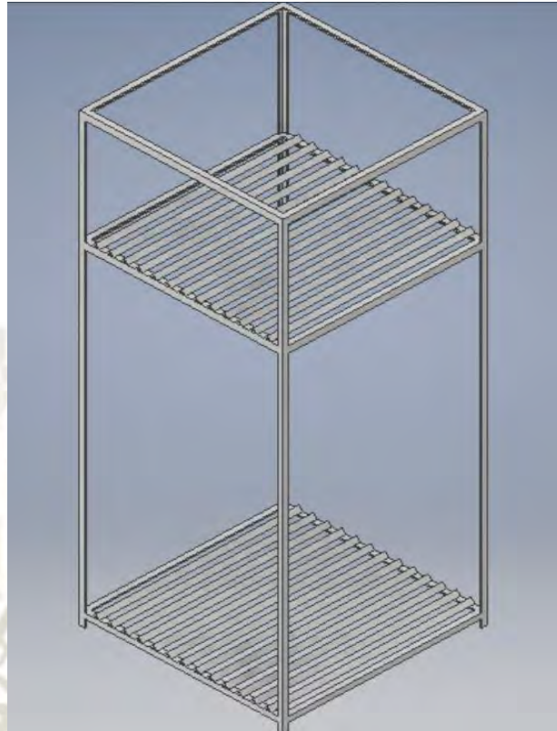
Figura 28. Base de tanques
