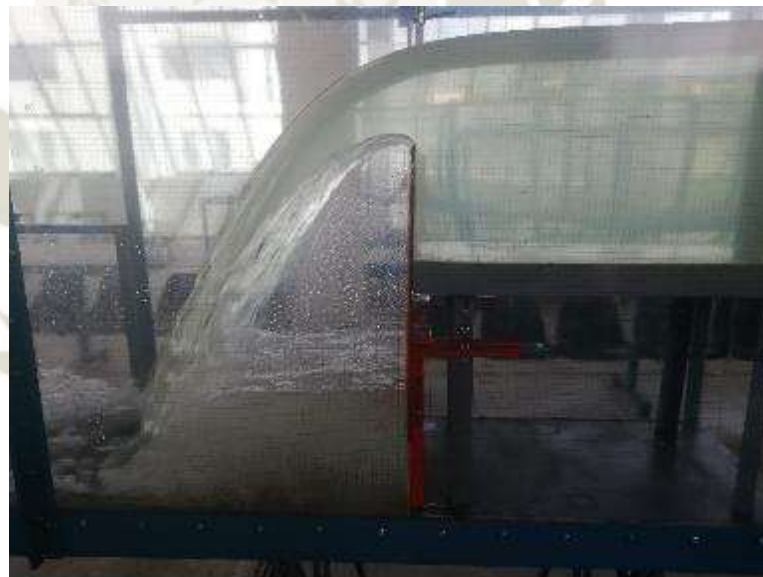
Fotografía N° 34.- Vertedero de pared delgada P = 20cm en funcionamiento (Q = 84 L/s)
