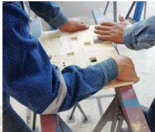
Fotografía N° 23.- Corte de piezas y lijado para la base de sensores
