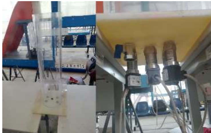
Fotografía N° 25.- Calibración de sensores
