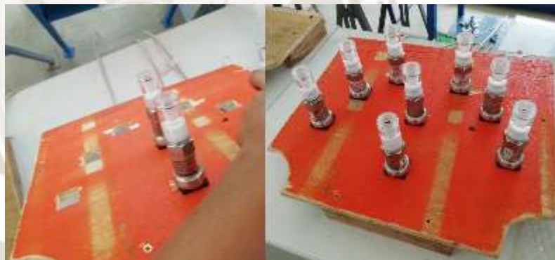
Fotografía N° 24.- Prueba de verticalidad y ajuste de sensores
