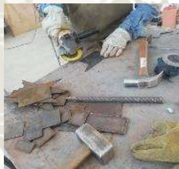
Fotografía N° 16.- Pulido y limpieza de piezas
