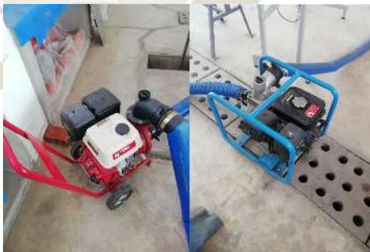
Fotografía N° 8.- Bombas de 15 hp y 7 hp (de izquierda a derecha)
