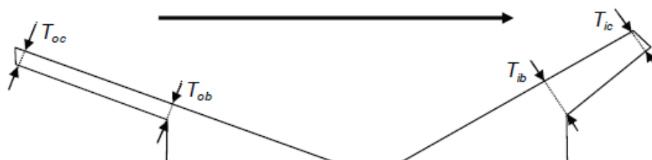
Figura N° 40.- Espesores en la base y extremo de los voladizos – aguas arriba (izquierda) y aguas abajo (derecha)
