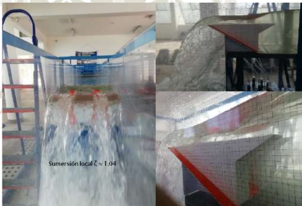
Fotografía N° 44.- Sumersión local en el Modelo 2 ( \zeta \approx 1.04 para Q = 62 L/s)
