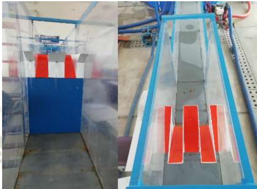
Fotografía N° 31.- Vista frontal y superior del vertedero en tecla de piano instalado
