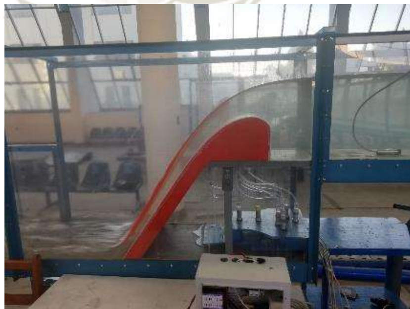
Fotografía N° 36.- Vertedero Creager P = 20cm en funcionamiento (Q = 60 L/s)
