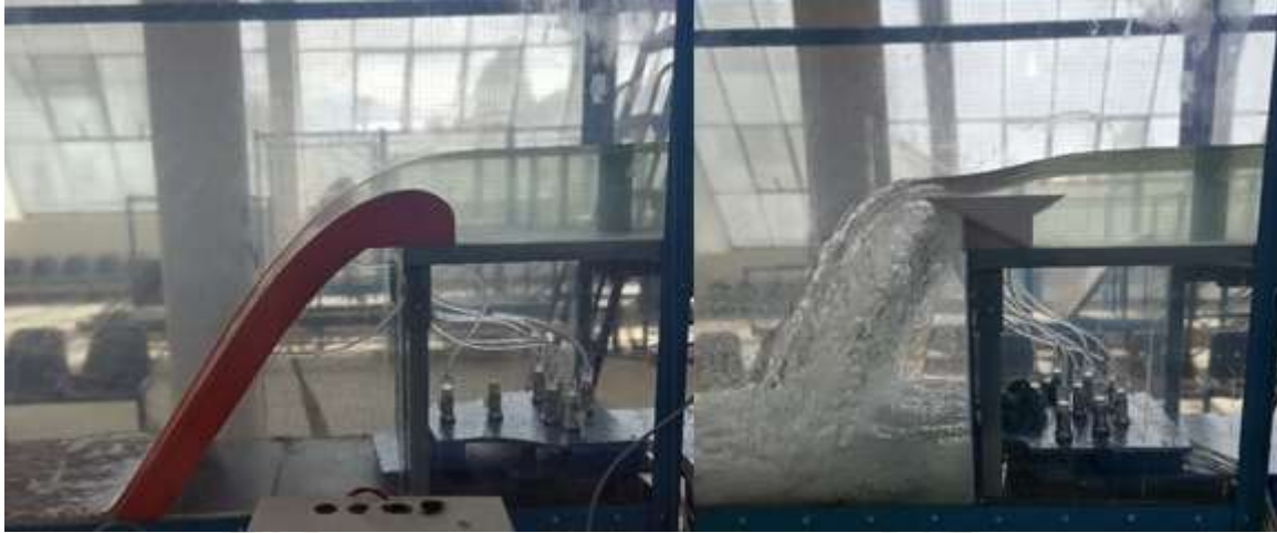
Fotografía N° 40.- Tirante: 0.17m para los Modelos 1. Vertederos Creager Q = 16 \text{ L/s} (izquierda) y PKW Q = 40 \text{ L/s} (derecha)
