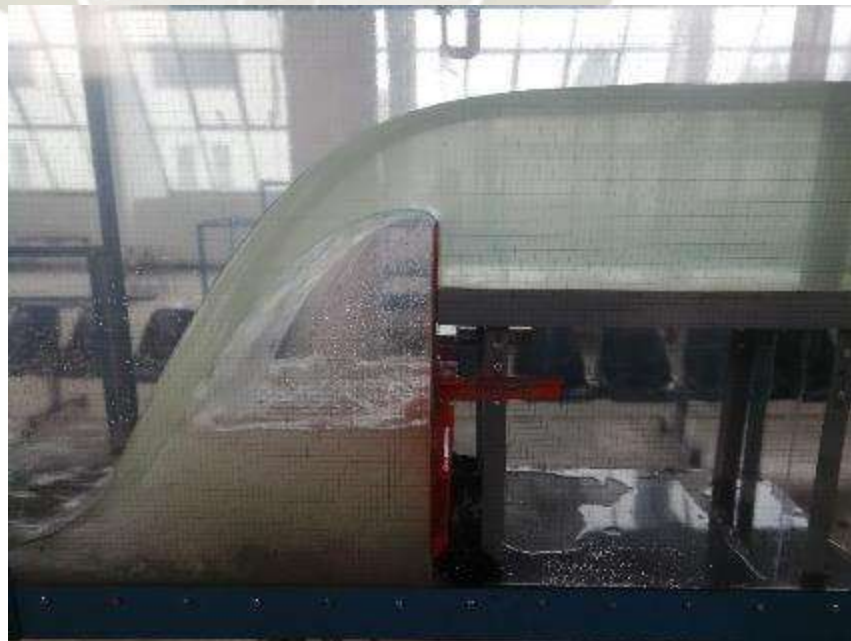
Fotografía N° 33.- Vertedero de pared delgada P = 10cm en funcionamiento (Q = 91 L/s)
