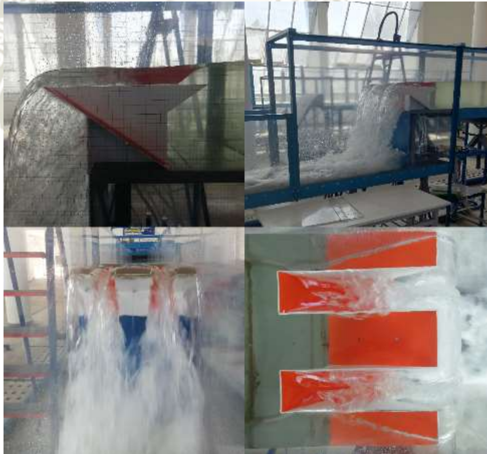
Fotografía N° 39.- Vertedero PKW 2 unidades en funcionamiento (Q = 33 L/s)
