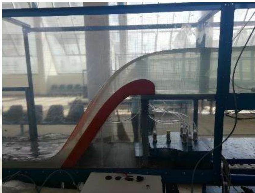
Fotografía N° 35.- Vertedero Creager P = 10\text{cm} en funcionamiento ( Q = 89\text{ L/s} )
