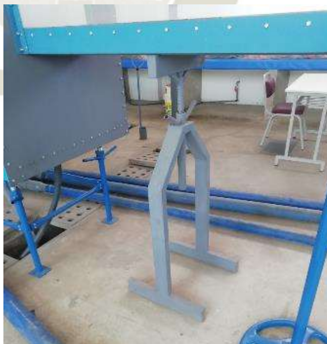
Fotografía N° 5.- Soporte típico del canal aguas arriba
