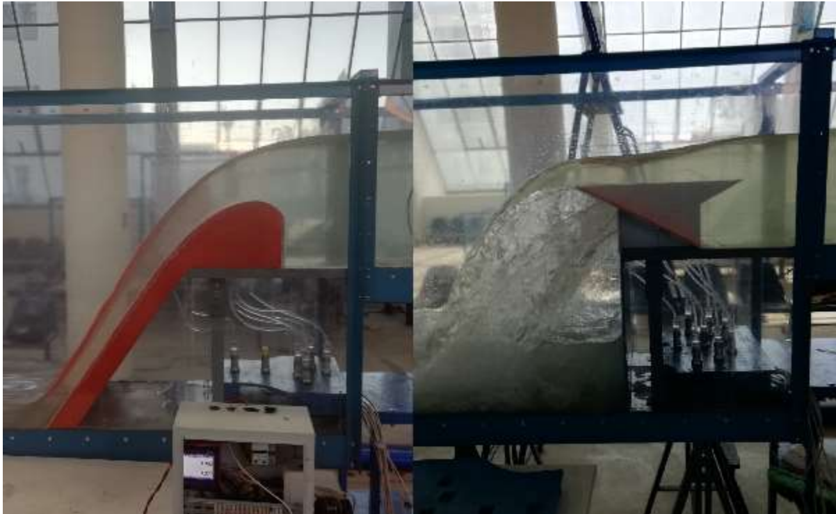
Fotografía N° 41.- Caudal: 89 L/s para los Modelos 2. Vertederos Creager H_u = 0.21\text{m} (izquierda) y PKW H_u = 0.149\text{m} (derecha)
