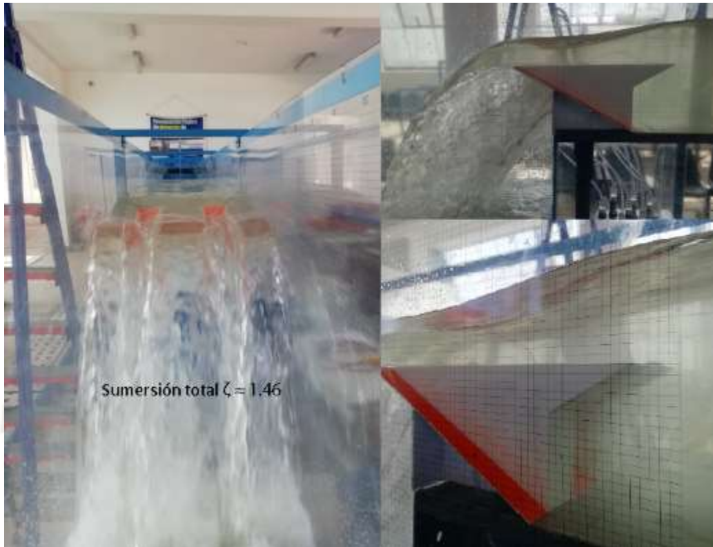
Fotografía N° 45.- Sumersión total en el Modelo 2 ( \zeta \approx 1.46 para Q = 88 L/s)
