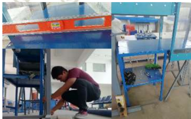
Fotografía N° 30.- Armado y nivelado de la mesa para base de sensores
