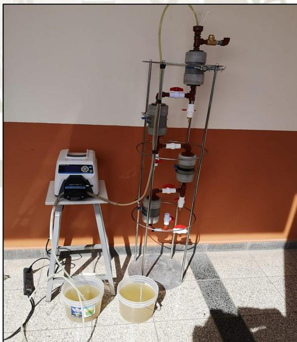
**Figura N° 27. Diseño final de la columna de filtración conteniendo los residuos agroindustriales y los componentes inorgánicos.**
