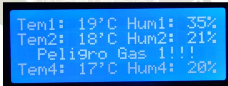
Figura 57: Prueba de presencia de Gas en el ambiente
