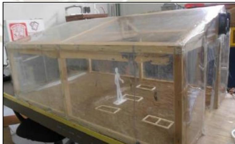
**Figura 1: Maqueta a escala del invernadero**
