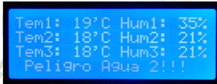
Figura 56: Prueba de presencia de agua
