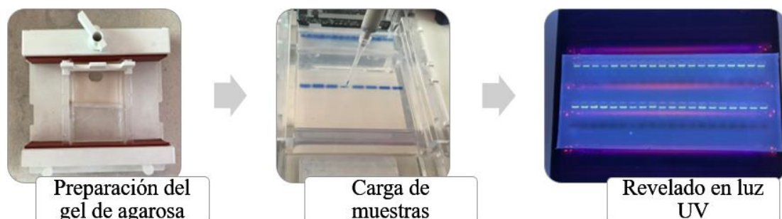
Figura 8. Metodología para la detección de productos mediante electroforesis.
